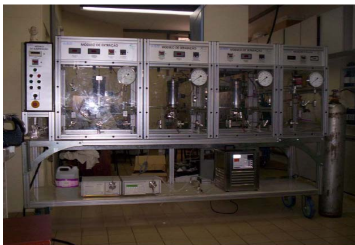
Figura III.2: Equipamento de extração supercrítica modular (LEPPbio/FEQ), desenvolvido por Azevedo (2005).
