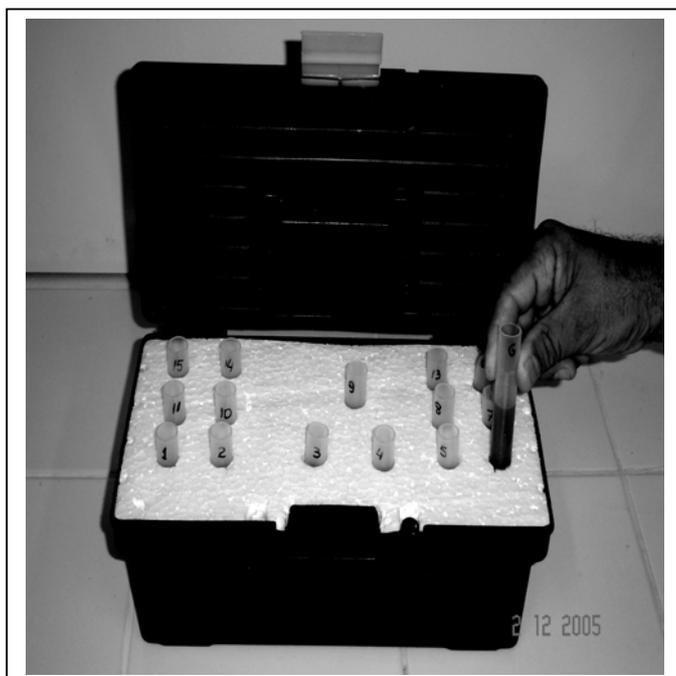
Figura II.6 - Banho de gelo objetivando interromper o processo de adsorção.
