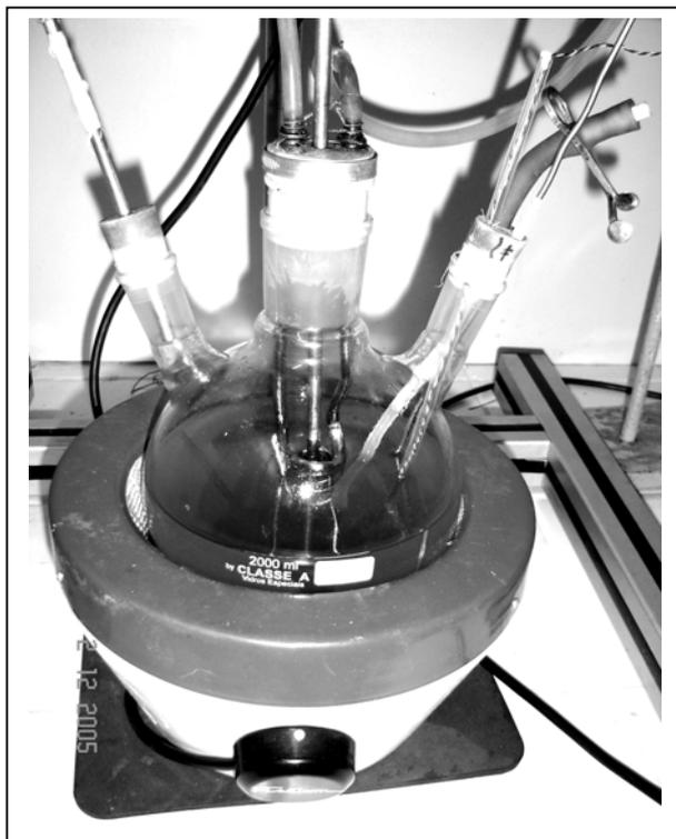
Figura II.3 - Vista do aparato utilizado no processo de descoramento do óleo de soja.
