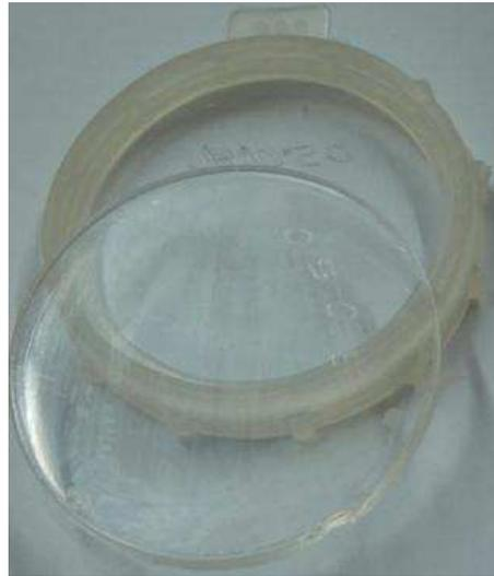
Figura 16 - Exemplo de gaxeta de silicone e moldes de vidro polido.
