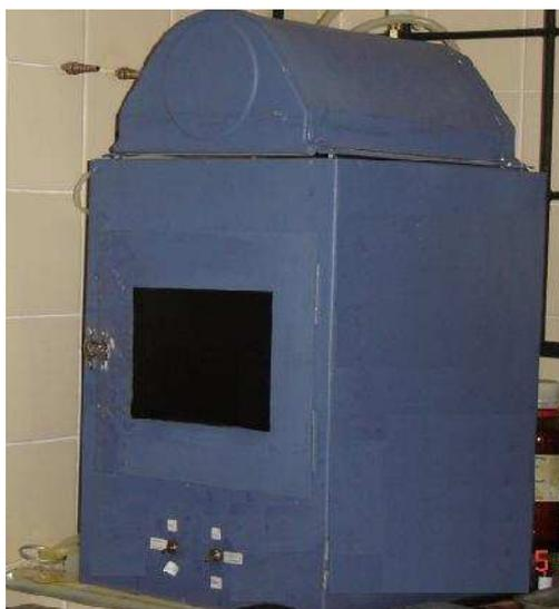
Figura 13 - Reator fotoquímico construído no laboratório para curas com luz ultravioleta.
