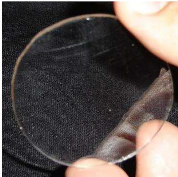
Figura 17 - Lente curada por ultravioleta.
