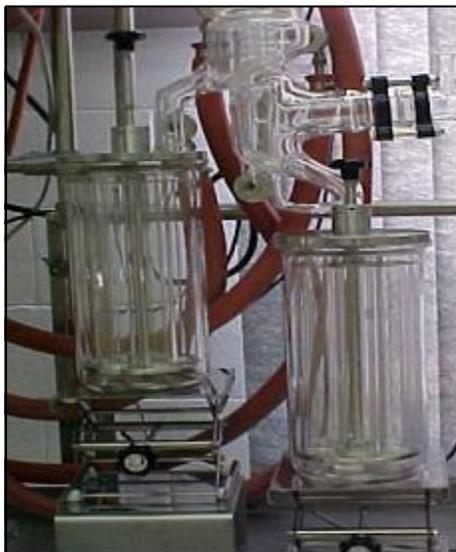
**Figura 3.2:** Foto em detalhe dos carrosséis coletores de resíduo e destilado do destilador molecular de filme descendente (SBAITE, 2005).
