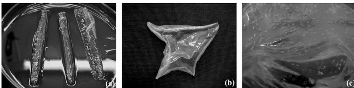
Figura 4.6 – Ilustrações de membranas densas de quitosana sintetizadas a partir de condições descritas na literatura, porém não apropriadas para o uso: (a) membranas que não se desprenderam dos moldes, enrolando-se após o tratamento com uma solução de hidróxido de sódio a 1 M, (b) membrana não plana e enrugada, após secagem à temperatura ambiente sem prensagem e (c) membrana com presença de bolhas, produzida a partir de uma solução não desaerada.
