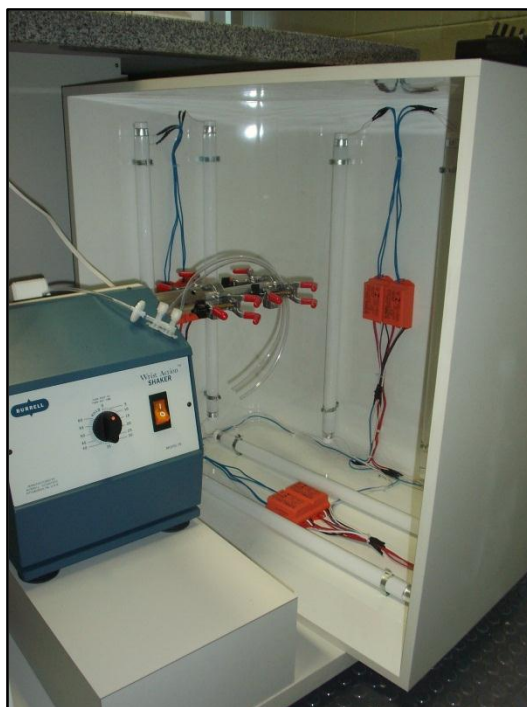
Figura 4—Câmara de fotoperíodo utilizada para propagação de microalgas
