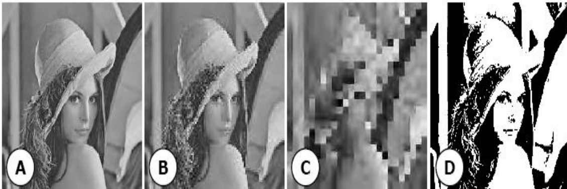
Figura 5: Influência da variação do número de amostras e de níveis de quantização na qualidade de uma imagem digital: (A) 200 x 200 pixels / 256 níveis; (B) 100 x 100 pixels / 256 níveis; (C) 25 x 25 pixels / 256 níveis; e (D) 200 x 200 pixels / 2 níveis
