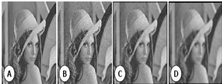
Figura 14: Filtro da média: (A) imagem original; (B) imagem ruidosa; (C) imagem filtrada com máscara 3x3; e (D) imagem filtrada com máscara 5x5 Fonte: Gonzalez, 2002
