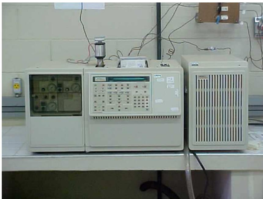
Figura 4.1: Cromatógrafo a gás Varian, modelo Star 3600 cx
