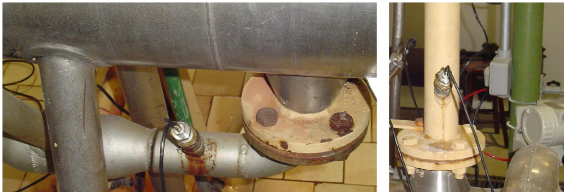
Figura 3.14 - Posicionamento dos elementos de medição das temperaturas da entrada (T4) e saída (T2) da água quente de aquecimento
