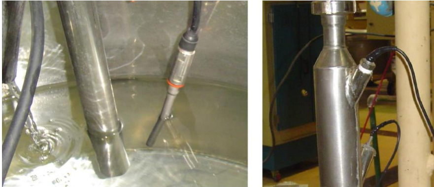
Figura 3.13 - Posicionamento dos elementos de medição de temperatura da entrada (T3) e saída (T1) do fluido de processo
