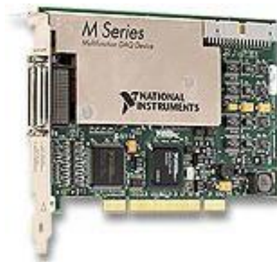
Figura 3.3 – Placa de aquisição de dados usada no trabalho Fonte: National Instruments, 2012
