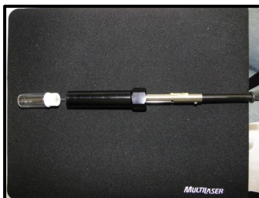
Figura 4-5 – Fibras SPME utilizadas: fibra colocada em holder utilizado nas amostragens.
