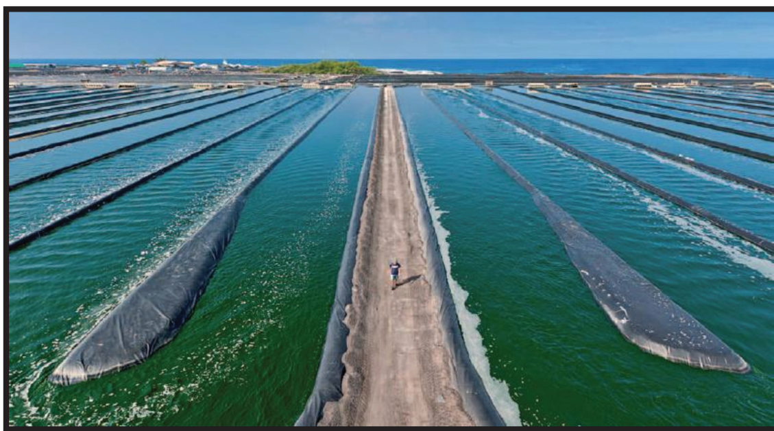
Figura 2-6 – Exemplos de fotobiorreatores utilizados em cultivos de microalgas com sistema aberto (open ponds). (SAVAGE, 2011)
