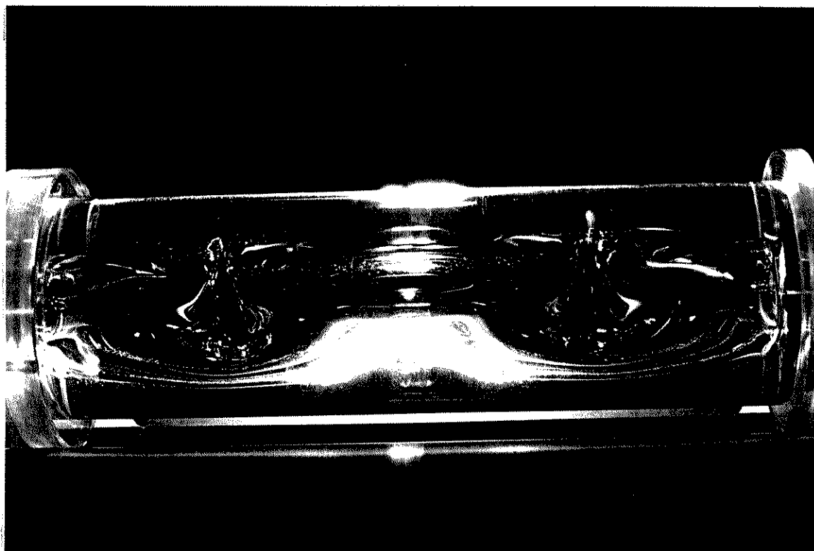
FIGURA IV-8: Ondas centrífugas oscilantes. Os "sulcos" na superfície ar-líquido oscilam, alterando seus posicionamentos periodicamente ao longo do comprimento do cilindro (óleo se silicone - 50 cStks, volume de 75%).
