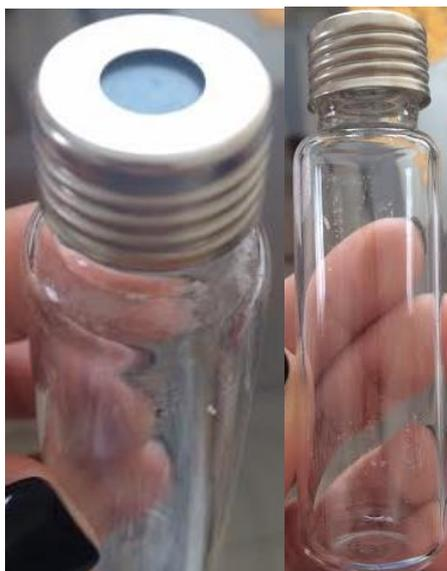
Figura 14 – Vial de borosilicato de 20 mL com septo de silicone e tampa rosqueável
