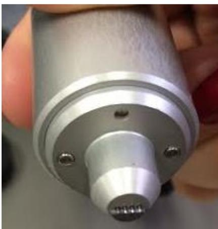
Figura A.1 – Medidor de condutividade JANDEL model RM 3, 4 pontas de ouro.
