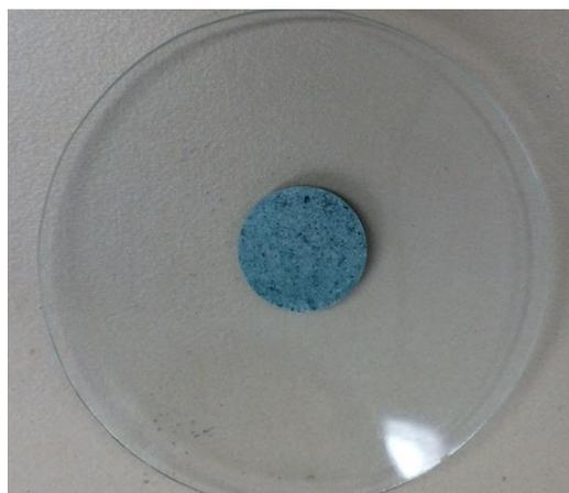
Figura 38 – Pastilha de PMMA via ATRP com 120 minutos de reação.
