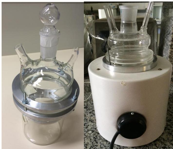
Figura 13 – Reator de vidro com manta de aquecimento acoplada
