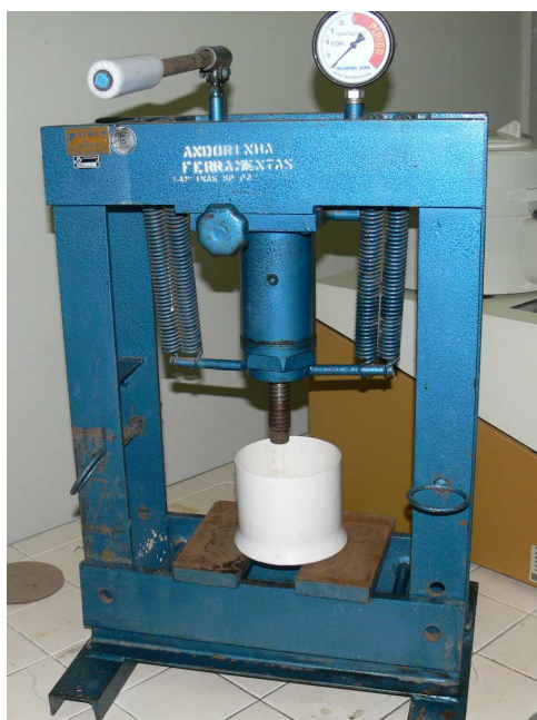
Figura 3.1. Sistema de prensagem usado para extração do suco de Caju.
