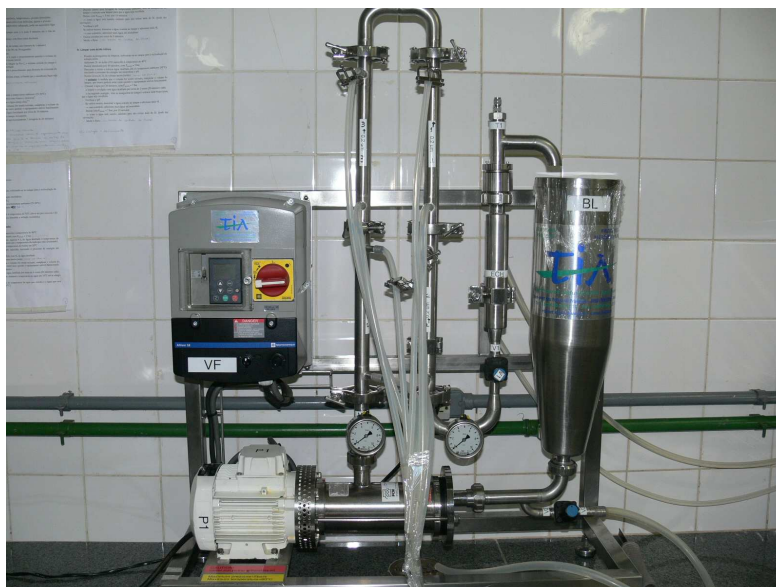
Figura 3.2. Sistema de Microfiltração Usado para Clarificar o suco de Caju.
