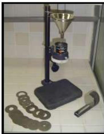
Figura 3.8 - Fotografia do medidor de escoabilidade, Powder Flowability Test Instrument – Flodex<sup>®</sup> (Cunha, 2009).
