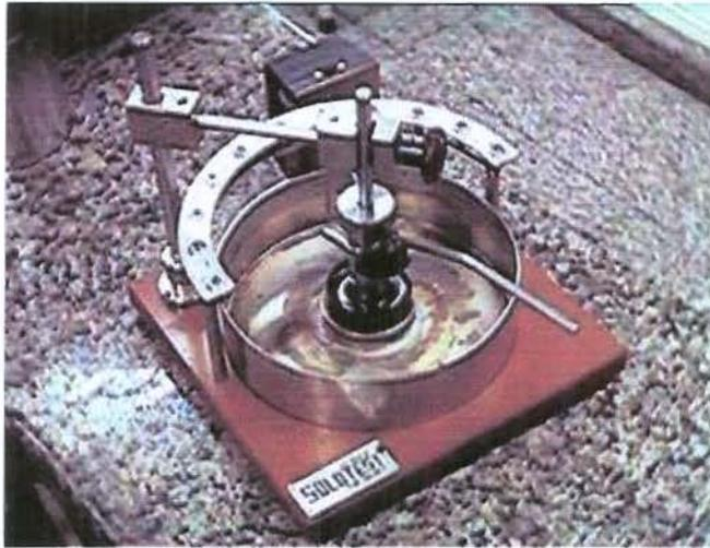
FIGURA 28 – Aparelho de recuperação elástica por torção.
