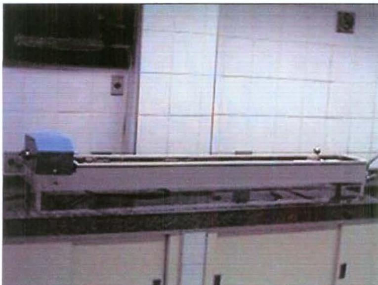
FIGURA 24 – Ductilômetro.
