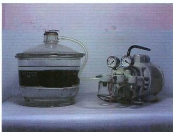
Figura 37: Equipamento para ensaio Lottman
