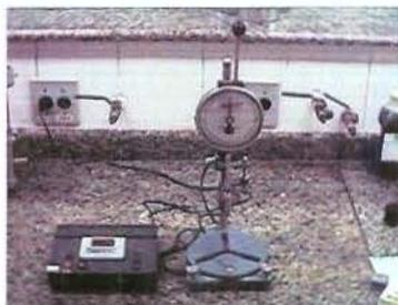
Figura 30: Penetrômetro
