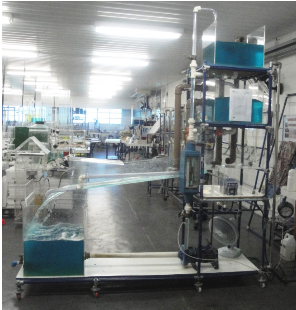
Figura 3.5 – Dois tanques em cotas diferentes no recalque da bomba.
