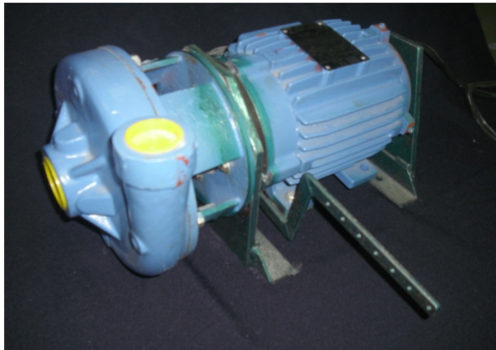
Figura 3.1 – Motor em balanço empregado no estudo para quantificação da potência consumida na transferência do fluido.
