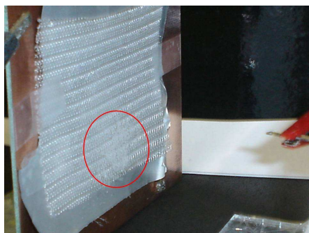
Figura 4.16- Formação de fibras, nas condições: agulha de 21G, tensão de 15 kV, vazão de 1 mL/h, distância de 7,5 cm entre agulha e coletor, concentrações de 1,6% de quitosana QB e de 2,5% de PEG solubilizados em 20% de água, 40% de ácido acético e 40% de acetona.
