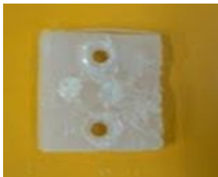
Figura 78. Recobrimento de pHEMA-PEUAPM após teste de desgaste na condição de ensaio de 1 MPa (solução A).
