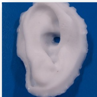
Figura 67. Hidrogéis de pHEMA em geometria específica de orelha (a) 40 % m/m HEMA (solução X); (b) todas as concentrações (solução X, Y e Z).
