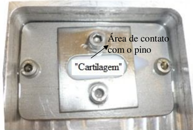
Figura 76. Dispositivo de fixação do recobrimento (placa de PEUAPM recoberta com hidrogel de pHEMA).
