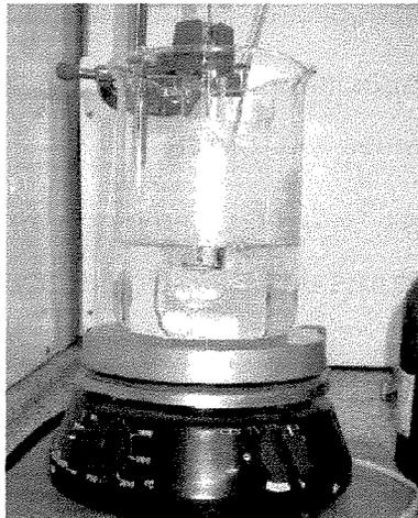
Fig. 17 – Foto do tubo de ensaio contido no banho água/gelo.
