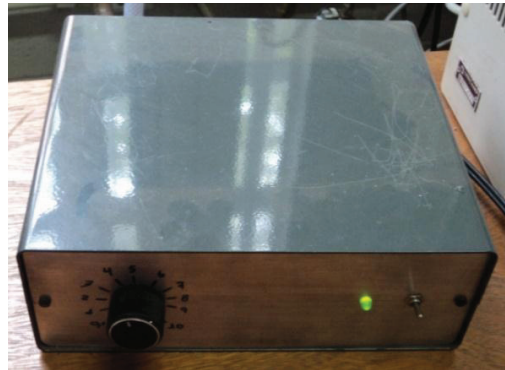
Figura 3.7: Potenciômetro utilizado para controle de ganho.
