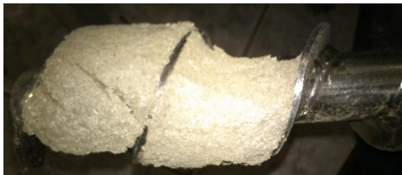
**Figura 24.** Compactação do bagaço na rosca transportadora devido à umidade superior a 10 %.
