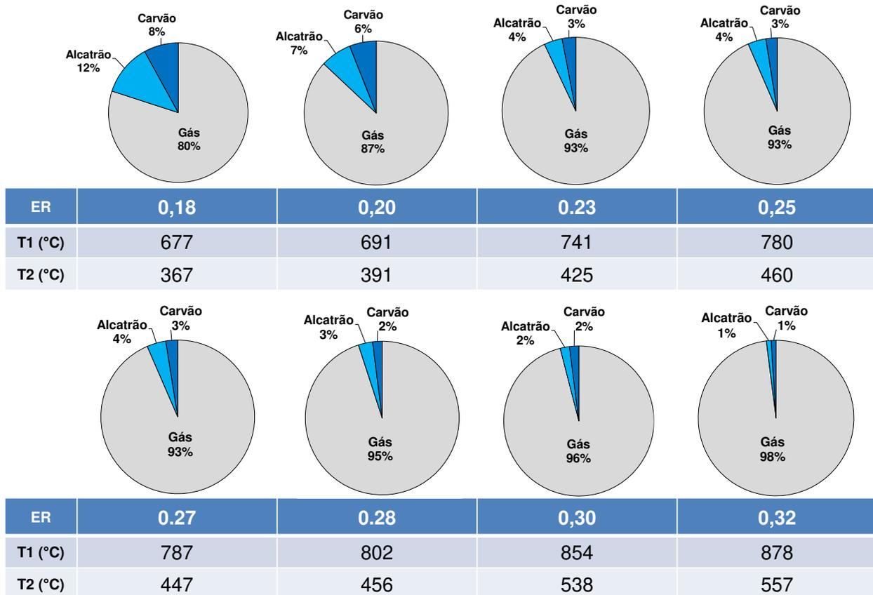
**Figura 36.** Efeito da relação ER sobre a distribuição de produtos e a temperatura de reação
