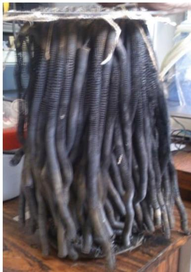
**Figura 28.** Catalisador de níquel após reações de reforma a vapor.
