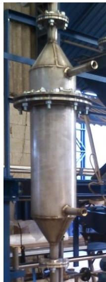
**Figura 27.** Reator de reforma a vapor sem resistência e isolamento.
