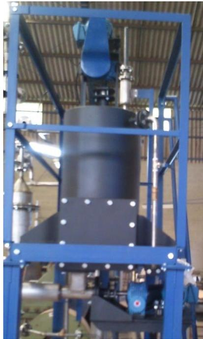
**Figura 23.** Sistema de alimentação de bagaço.
