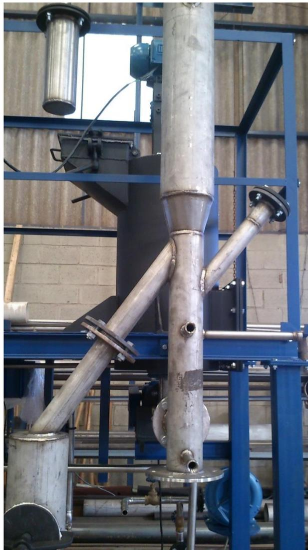
**Figura 26.** Reator de leito fluidizado sem resistências e isolamento térmico.
