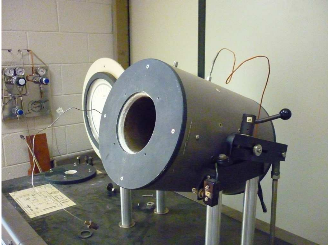
Figura 4.4: Sistema de aquecimento da célula de equilíbrio
