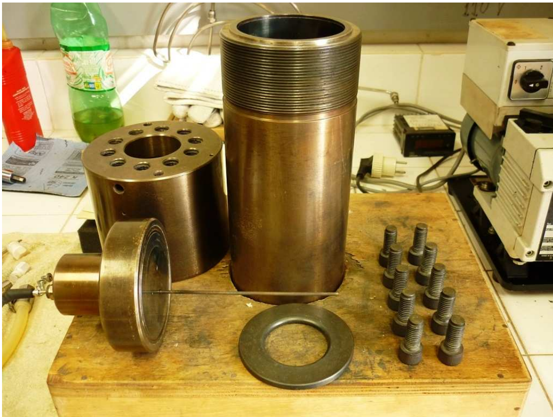
Figura 4.1: Célula de equilíbrio desmontada
