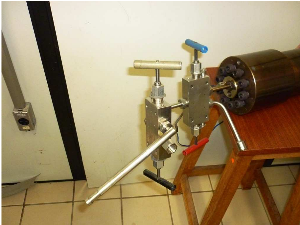
Figura 4.3: Célula de equilíbrio montada com o comando de válvulas
