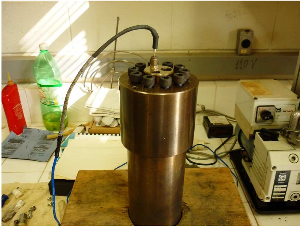
Figura 4.2: Célula de equilíbrio montada
