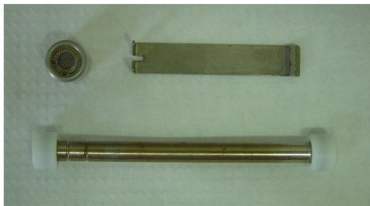
Figura 5.7 – Tubos de amostragem e acessórios utilizados no monitoramento passivo.
