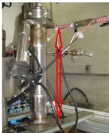
Figura 79. Redução no comprimento do vaso separador.
