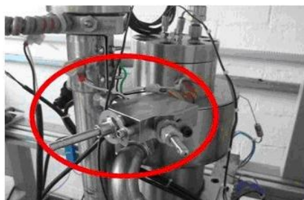
Figura 78. Incorporação das válvulas de bloqueio e micrométrica num só sistema.
