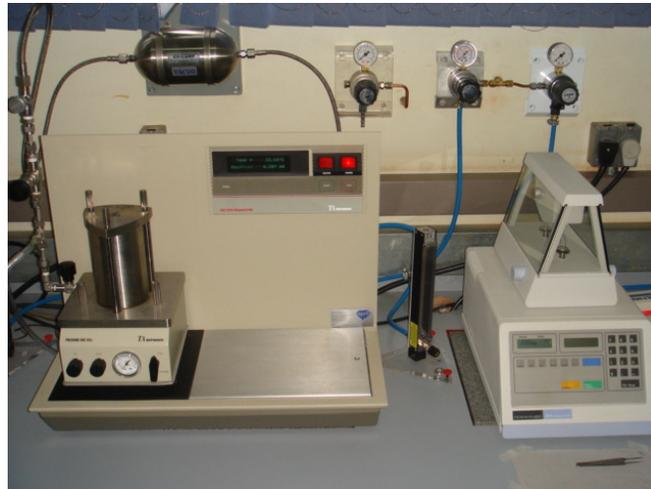
Figura 12: DSC de fluxo de calor, modelo 2920, TA Instruments. Laboratório EXTRAE, FEA, UNICAMP.
