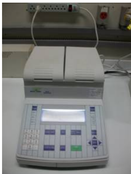
Figura 3.3. Foto do Refratômetro Mettler-Toledo, modelo RE 40D.
