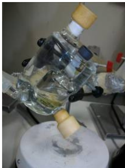
Figura 3.8. Célula em repouso para obter duas fases límpidas.
