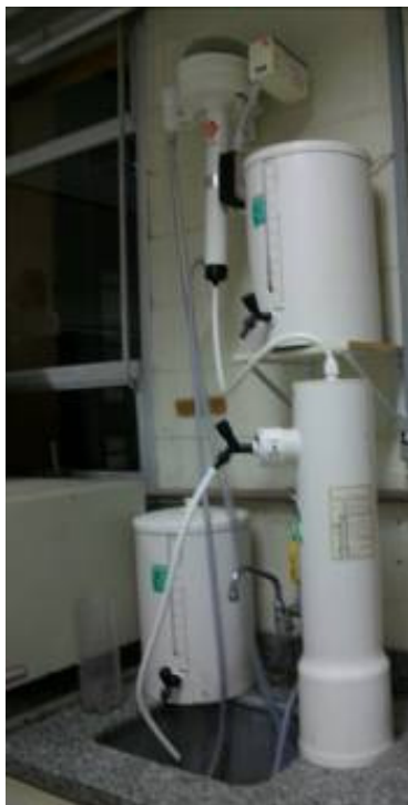
Figura 3.1. Destilador e coluna de troca iônica para purificação da água.
