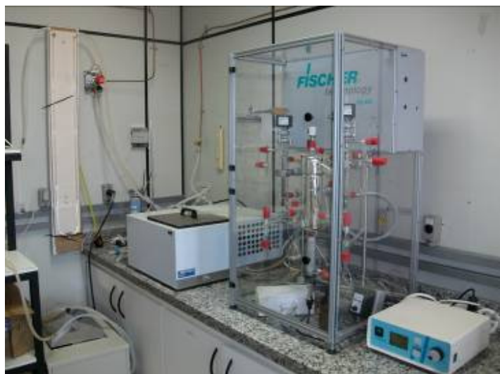
Figura 3.6. Foto do ebulliômetro Fisher Labodest, modelo VLE-602.
