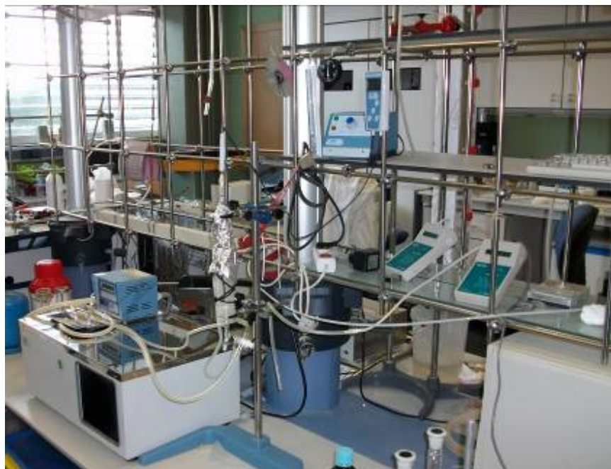
Figura 3.14. Foto dos aparelhos utilizados para medir a absorção de CO 2 nos líquidos iônicos.
