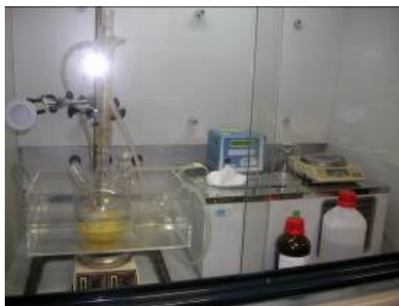
Figura 3.9. Foto da montagem utilizada para a síntese dos líquidos iônicos.
