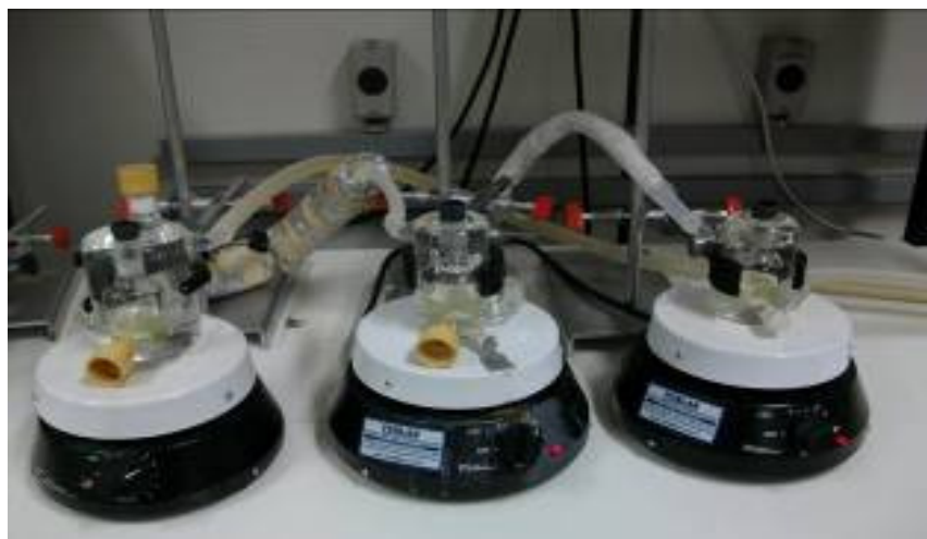
Figura 3.15. Foto de três células em série para determinar o ELL, com mistura sob agitação.
