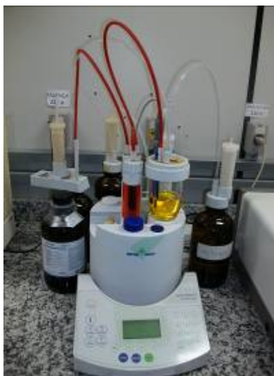
Figura 3.5. Foto do Titulador de Karl-Fisher, modelo DL31.
