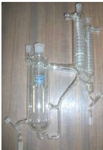
Figura 3.13. Foto do Ebuliômetro tipo Othmer.
