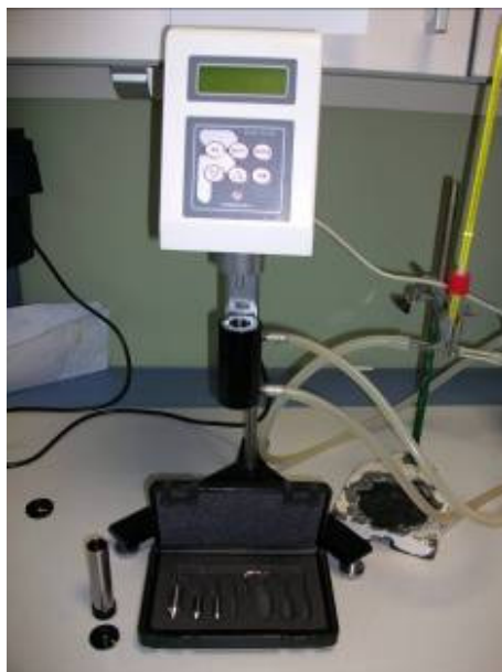
Figura 3.4. Foto do reômetro Visco Elite, modelo L.
