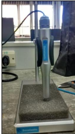
Figura 18. Ensaio não destrutivo de excitação por impulso utilizando equipamento Sonelastic.
