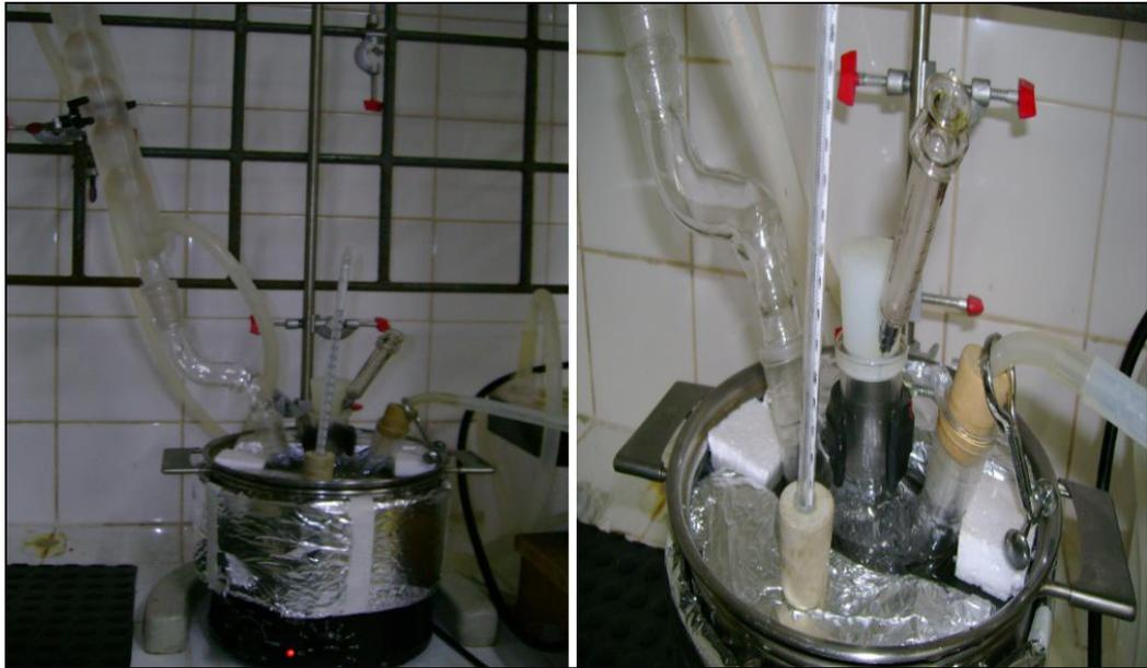
Figura 10. Equipamento experimental para copolimerização em miniemulsão.
