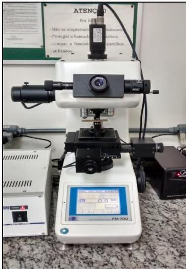
Figura 17. Microdurômetro digital com diamante de Knoop.
