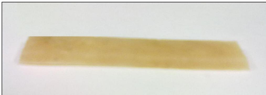
Figura 14. Corpo de prova de resistência à flexão da resina permanente.
