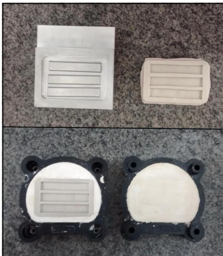
Figura 12. Representação da matriz metálica, moldagem em silicone e mufla e contra-mufla com matriz em silicone.
