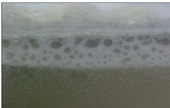
Figura 16: Foto da camada de bolhas que vai sendo formada com o decorrer do tratamento.
