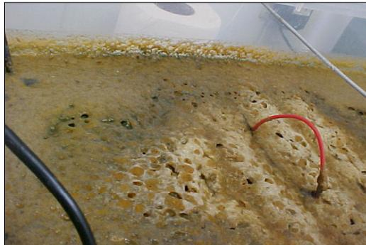
Figura 19: Foto da espuma gerada durante a eletroflotação.
