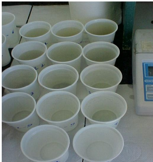
Figura 17: Acompanhamento da alteração da cor do efluente com o decorrer do tempo de tratamento com a colméia de alumínio.
