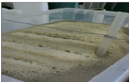
Figura 15: Foto da espuma gerada durante a eletroflotação.
