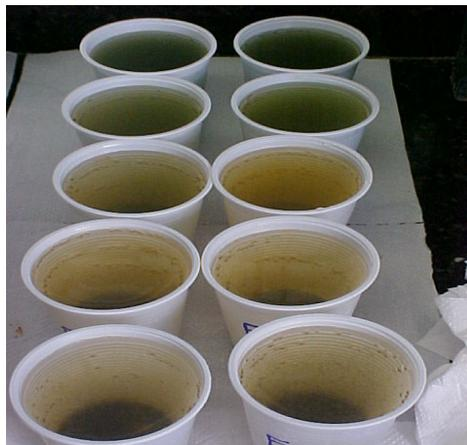
Figura 20: Acompanhamento da alteração da cor do efluente com o decorrer do tempo de tratamento com a colméia de ferro.
