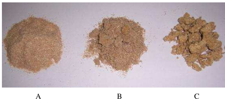
Figura 4.27. Bagaço pré-tratado com ácido fosfórico e deslignificado com hidróxido de sódio. A- bagaço sem pré-tratar, B- bagaço pré-tratado com ácido fosfórico, C- bagaço pré-tratado com ácido fosfórico e deslignificado com hidróxido de sódio.
