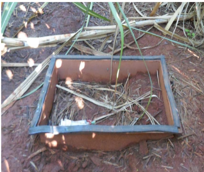
**Figura 4:** Detalhes de câmara estática inserida no solo no experimento
