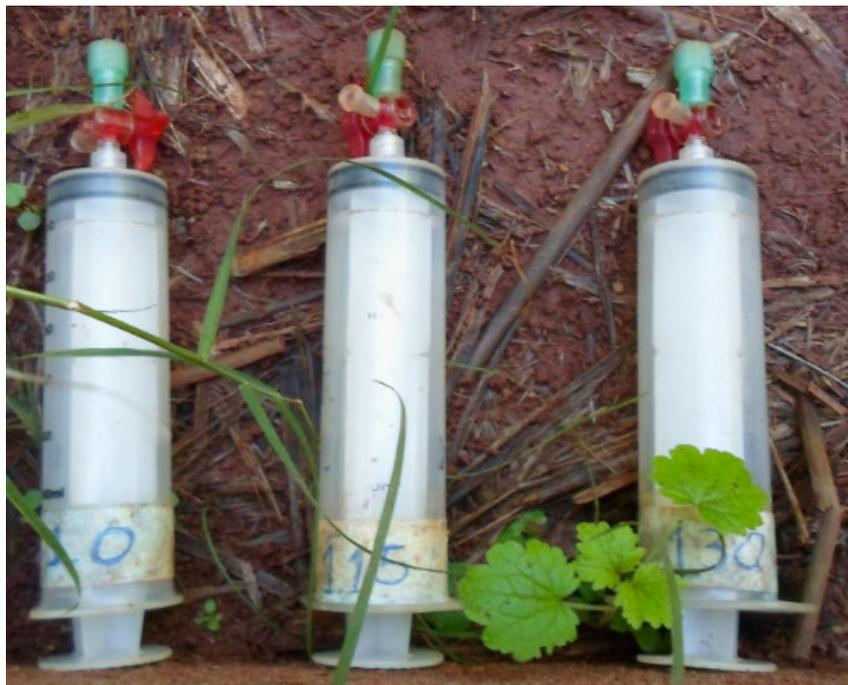
**Figura 7:** Amostradores (seringas) para coleta de gases de  $N_2O$  na câmara estática.
