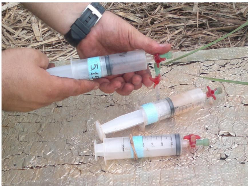
**Figura 8:** Coleta do ar da câmara estática com as seringas.
