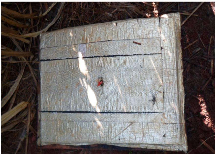
**Figura 5:** Detalhes da tampa da câmara estática revestida com manta adesiva.
