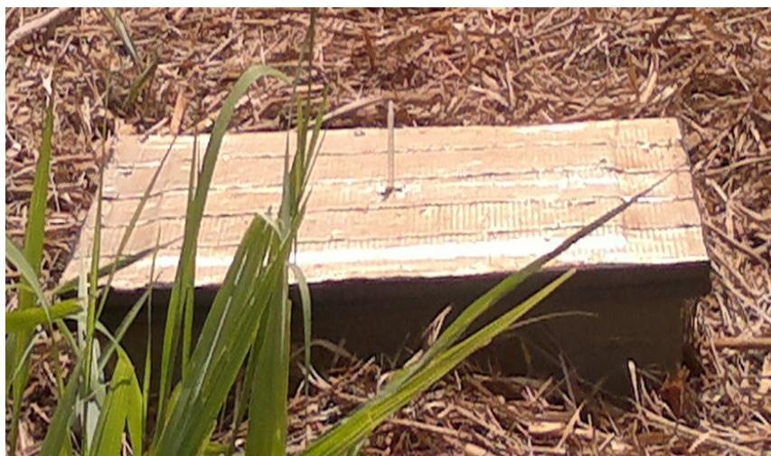
**Figura 6:** Detalhe das câmaras estáticas fechadas.
