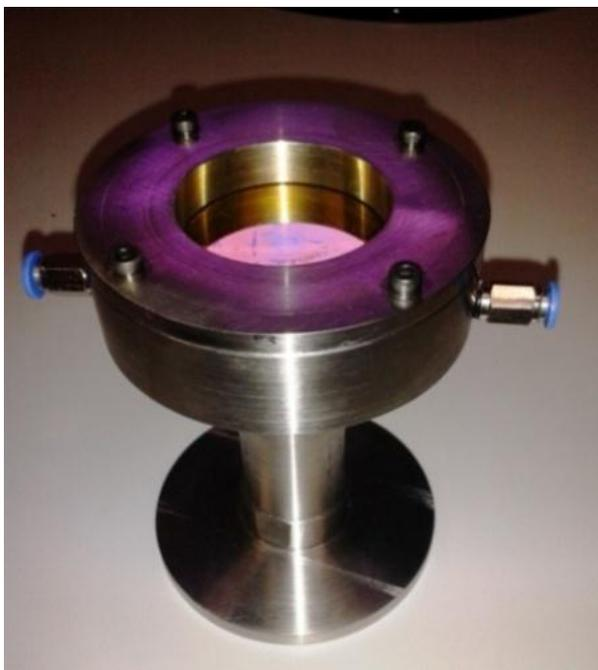
**Figura 7.2.** Microrreator tubular feito em aço inox.
