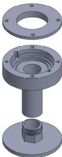
**Figura 5.1.** Modelo físico do microrreator estudado.
