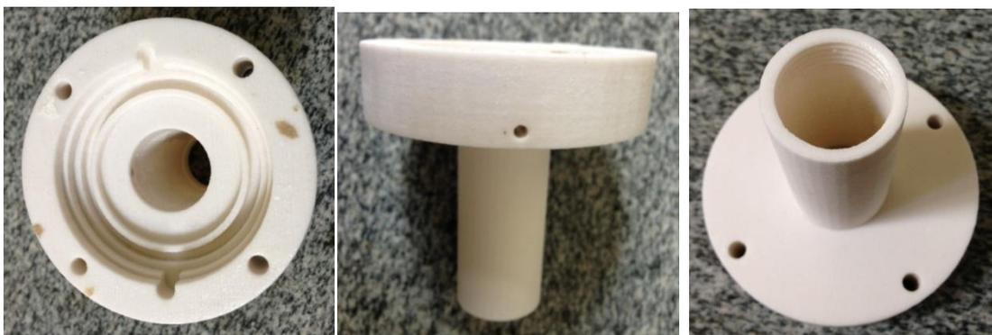
**Figura 5.5.** Imagens do protótipo do microrreator fabricado a partir da prototipagem rápida e impressão tridimensional (3DP).
