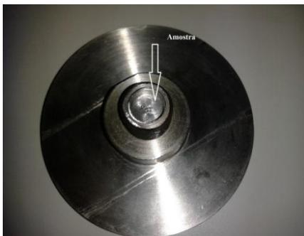
**Figura 5.8.** Imagem da base do microrreator e porta amostra.
