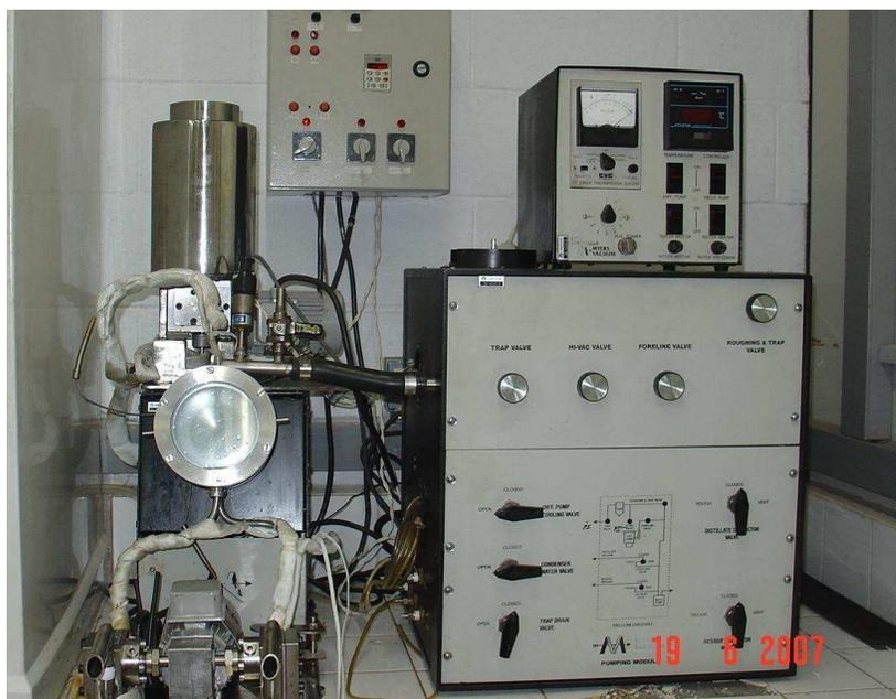
Figura 24 – Destilador molecular centrífugo, escala laboratorial.
