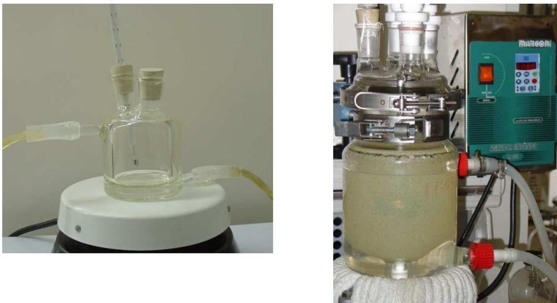
Figura 22 – Reatores de vidro utilizados em reações de glicerólise enzimática; (A) Reator de 70 mL com agitação magnética; (B) Reator de 2 L com agitação mecânica.
