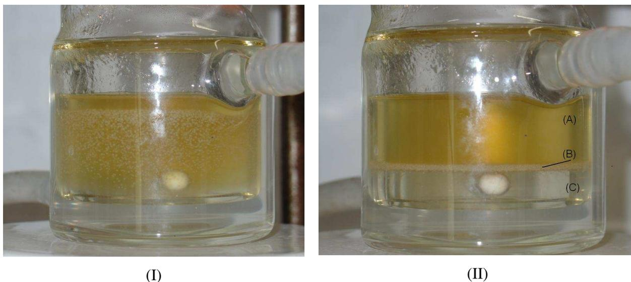
Figura 34 – Início da Separação de fases após 24 horas com lipase imobilizada de CA-IM (I), Separação de fases completa após 24 horas (II): (A) acilgliceróis, (B) lipases, (C) glicerina e água.
