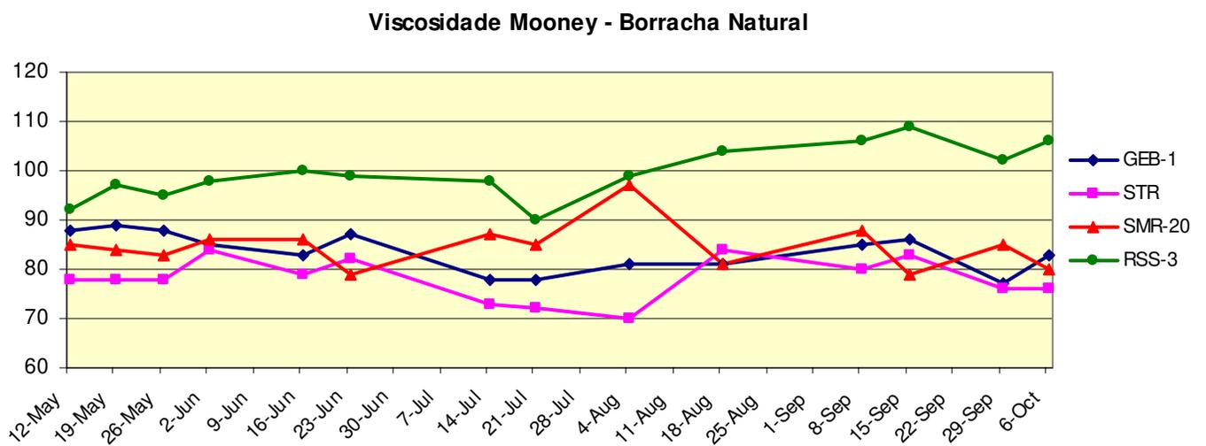
Figura 4.2 – Viscosidade da Borracha Natural utilizada no estudo.
