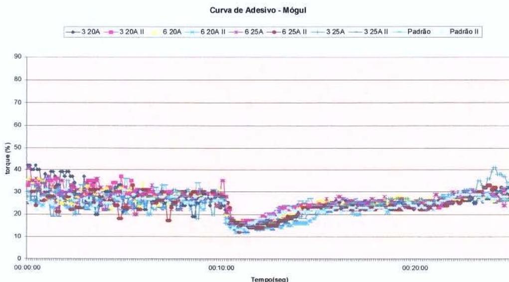
Figura 44: Curvas de torque dos adesivos (Mógul)
