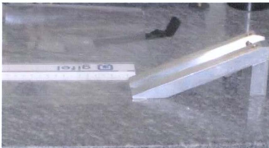
Figura 35: Ensaio de “rolling ball” (“tack”)
