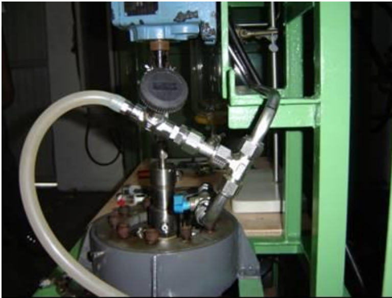
Figura 55. Montagem das conexões do sistema de vácuo do reator.
