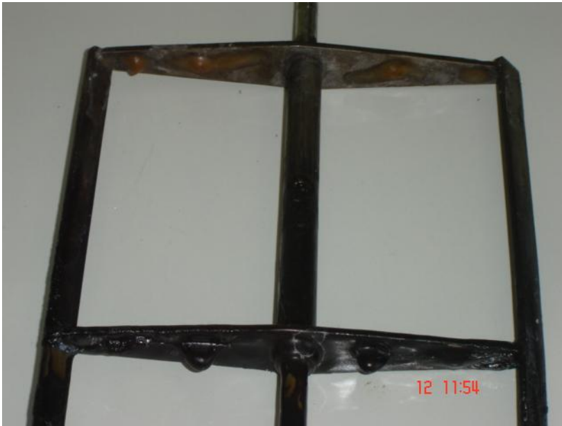
Figura 81. Detalhe da incrustação na parte superior da âncora de agitação do reator.
