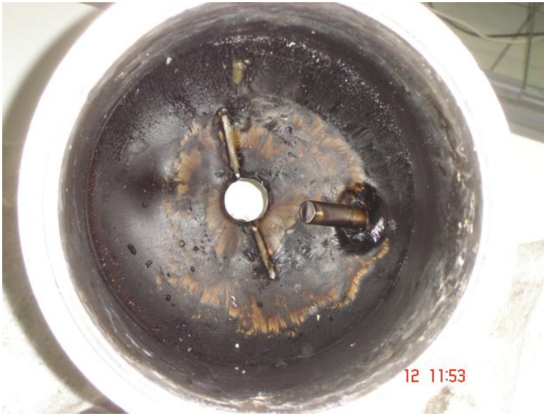
Figura 77. Detalhe da incrustação no fundo do reator e poço do sensor de temperatura.
