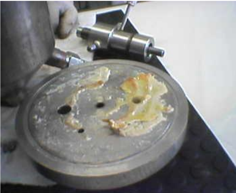
Figura 74. Detalhe da incrustação na superfície interna da tampa do reator.
