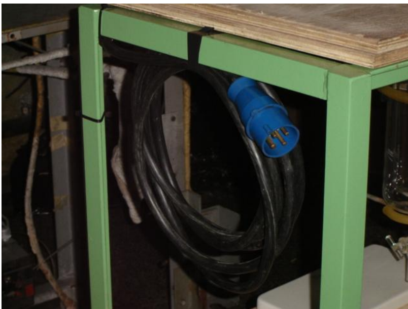
Figura 58. Cabo de alimentação de energia da unidade experimental.
