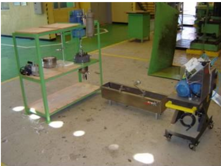
Figura 49. Alinhamento da estrutura de sustentação da unidade experimental com a bacia de resfriamento e o granulador de polímero.
