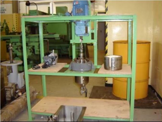
Figura 45. Fixação do Reator e Moto-redutor na parte móvel da estrutura de sustentação; Acoplamento do moto-redutor ao sistema de agitação do reator com eixo cardan.
