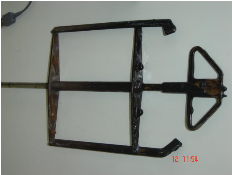
Figura 79. Detalhe da incrustação na âncora de agitação do reator.
