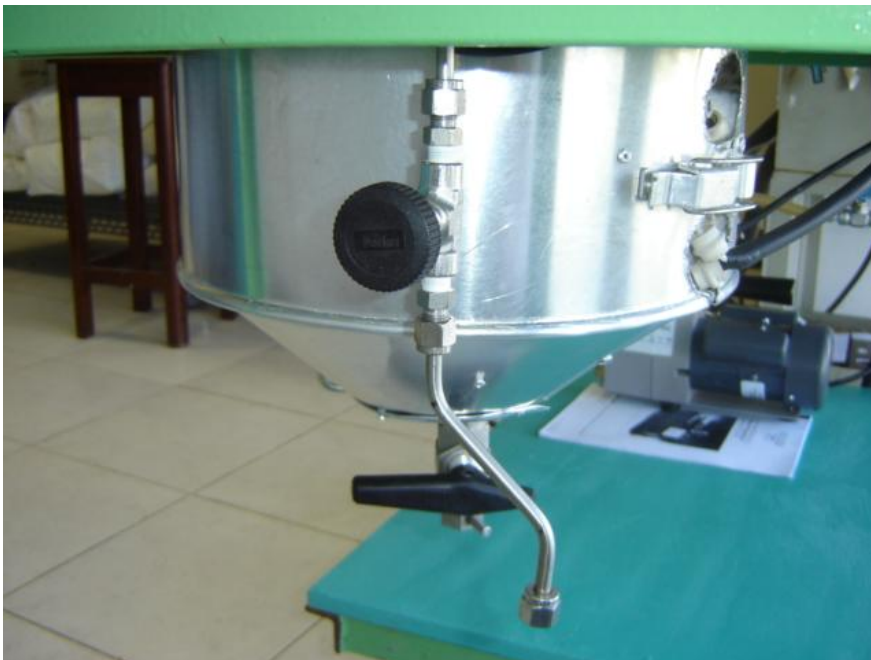
Figura 66. Fixação do sistema de isolamento térmico e saída do sistema de vent do reator.
