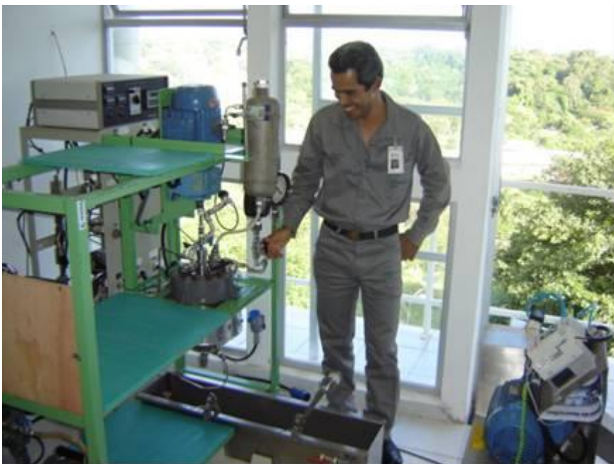
Figura 68. Unidade experimental com alocação da banheira de resfriamento e granulador.
