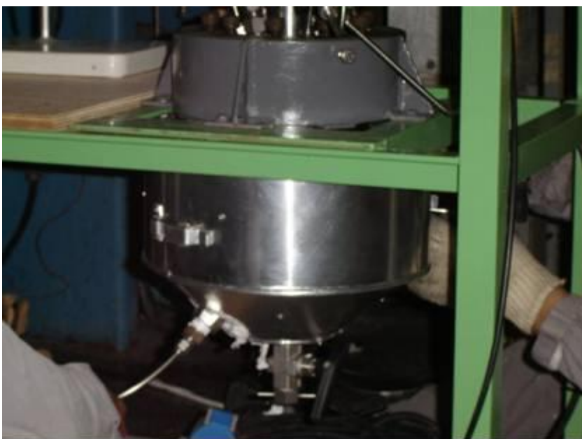
Figura 60. Detalhe da instalação do sensor de temperatura, da resistência elétrica e do sistema de isolamento térmico do reator.
