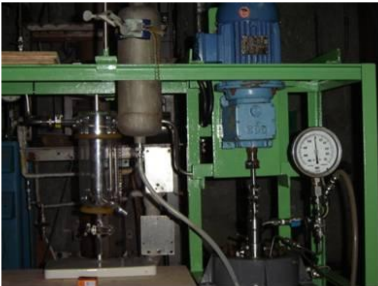
Figura 56. Interligação do vaso de alimentação e instalação do manômetro na conexão da tampa do reator.
