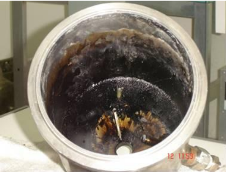
Figura 76. Detalhe da incrustação nas paredes internas e fundo do reator.
