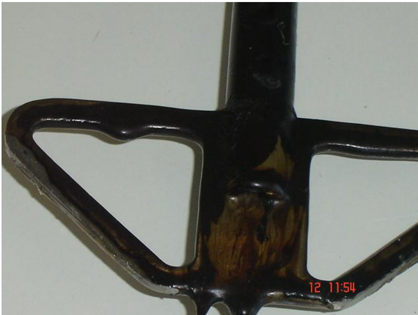
Figura 80. Detalhe da incrustação na parte inferior da âncora de agitação do reator.
