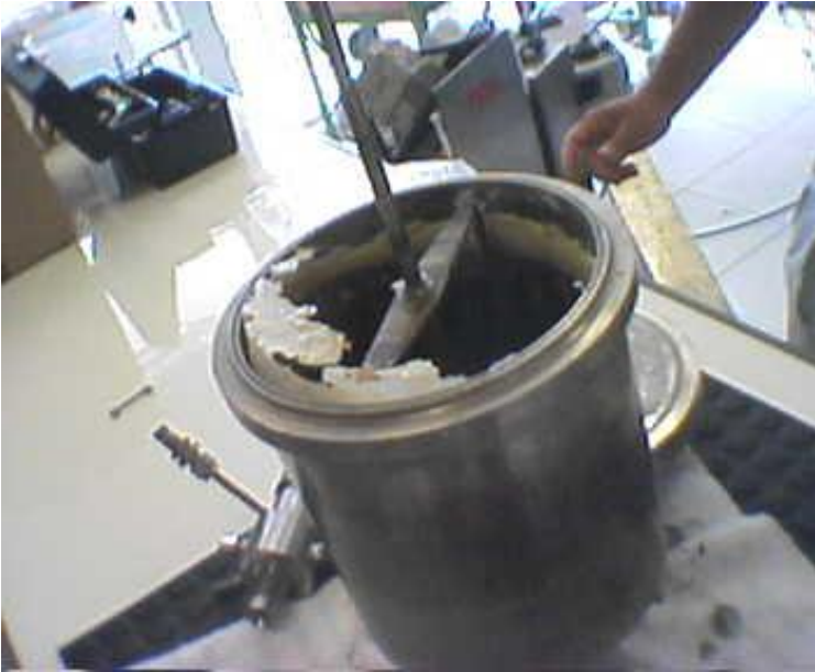
Figura 73. Detalhe da Incrustação na parte interna no reator e âncora de agitação.
