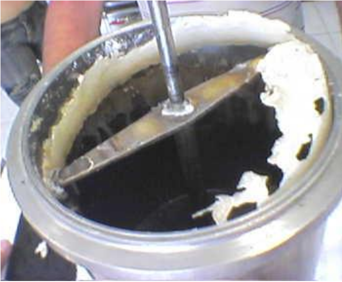
Figura 75. Detalhe da incrustação nas paredes do reator.
