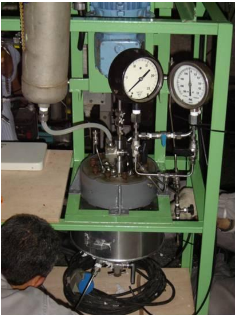
Figura 62. Reator de polimerização com interligações dos sistemas de alimentação, vácuo, nitrogênio/vent, aquecimento, isolamento e indicação de pressão.
