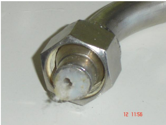
Figura 84. Detalhe do entupimento da linha de vácuo: (a) conexão de entrada do reator; (b) conexão da linha de vácuo (reator - trap de gases).
