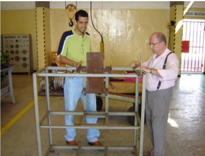
Figura 44. Estrutura de Sustentação fabricada – parte fixa e móvel com suporte do redutor adaptado, ainda sem proteção de corrosão e pintura.
