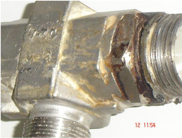
Figura 83. Detalhe da vedação da válvula de fundo do reator.
