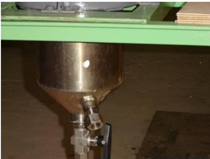
Figura 48. Detalhe da parte inferior do reator com destaque para o poço lateral para conexão do sensor de temperatura e para a válvula de fundo.
