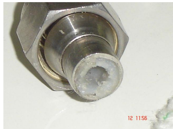
Figura 84. Detalhe do entupimento da linha de vácuo: (a) conexão de entrada do reator; (b) conexão da linha de vácuo (reator - trap de gases).
