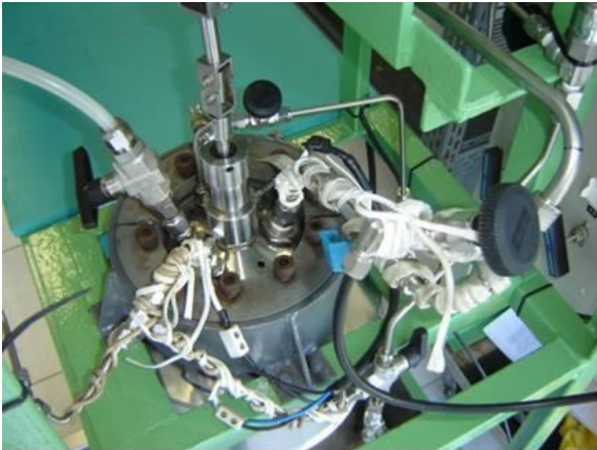
Figura 67. Vista superior do reator com os sistemas instalados e interligados, incluindo o sistema de alívio e segurança.
