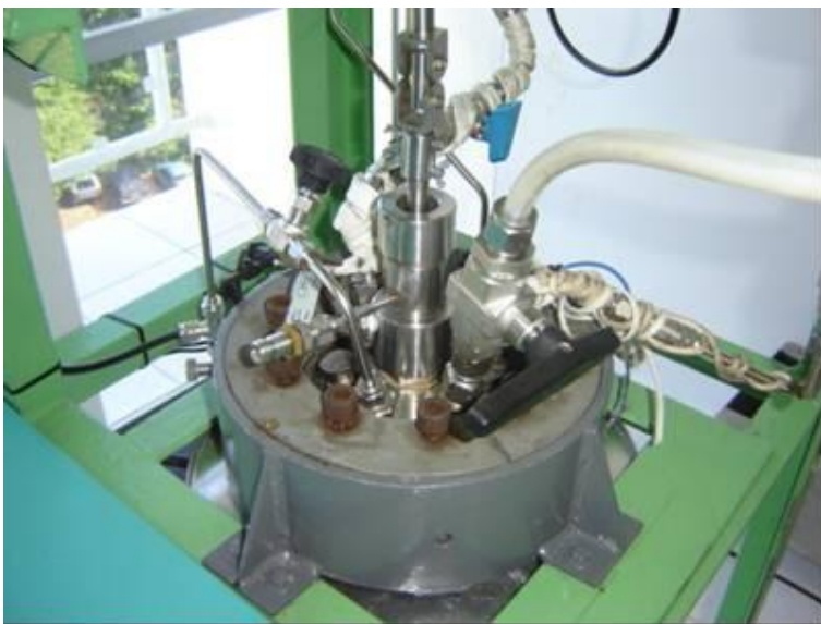
Figura 63. Detalhe do Reator com instalação de fitas térmicas de aquecimento nas linhas de vácuo e vent.
