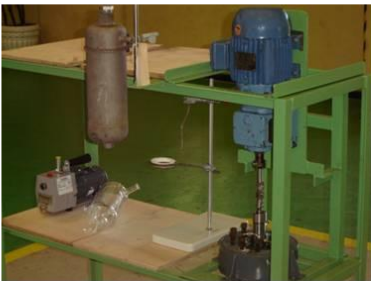
Figura 50. Alocação do vaso de alimentação, para interligação com o reator.
