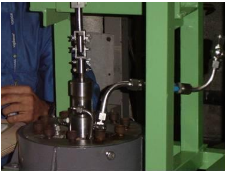
Figura 51. Montagem das conexões de interligação na tampa do reator: alimentação de nitrogênio, sistema de vácuo e sistema de alimentação.
