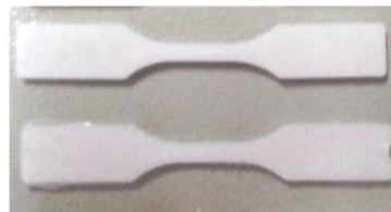
Figura 13. Corpos de prova usados no teste de resistência à tração.
