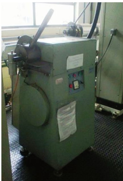
Figura 9. Homogeneizador Drais M.H. Equipments , modelo MH-100/200V.
