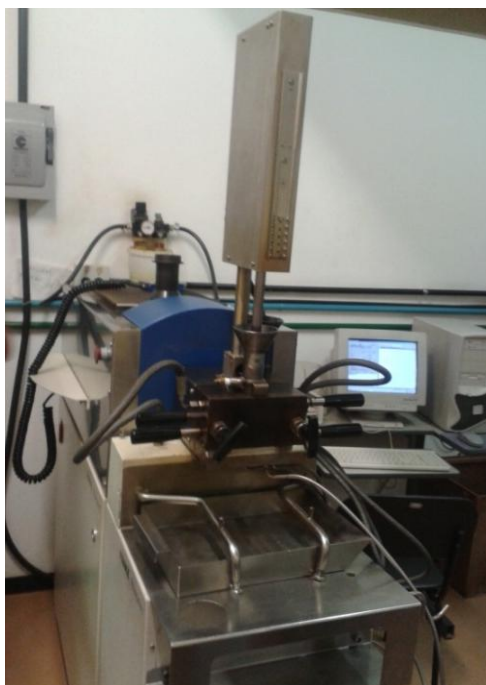
Figura 10. Reômetro de torque HAAKE Rheomix 600P.
