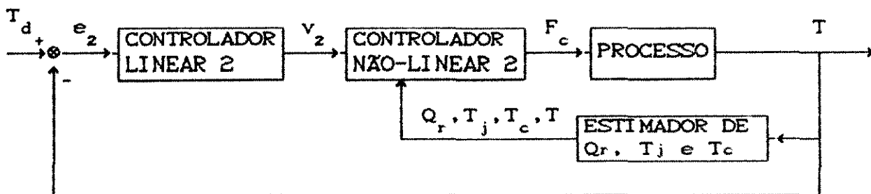
FIGURA 4.2 - Esquema da malha de controle de temperatura do meio reacional para a etapa de resfriamento do reator, com a utilização da estratégia de controle GLC.
