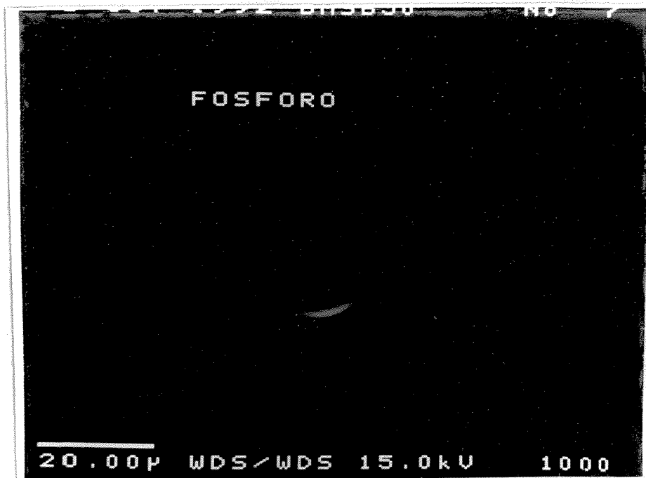
Figura 3.9 - Mapeamento do fósforo no catalisador BMSB50 novo
