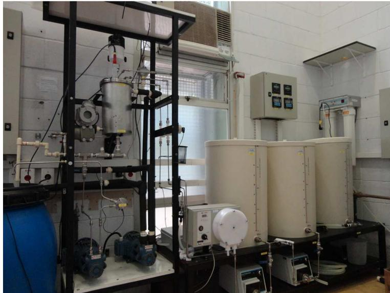
Figura 4.3: Processo experimental de neutralização.
