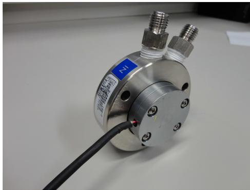
Figura 4.11: Sensor de vazão FE-104 (Signet GF-2502) conectado na linha de saída do reator.
