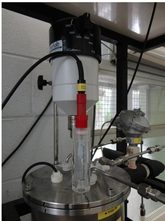
Figura 4.5: Visão superior do reator de neutralização.
