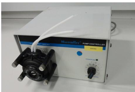
Figura 4.7: Bomba P-105 de baixa vazão para alimentação de NaHCO<sub>3</sub>.
