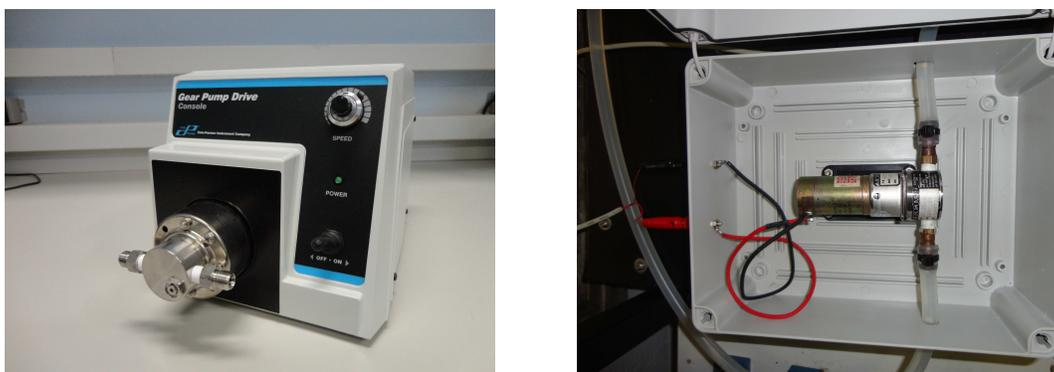
Figura 4.6: Bombas para alimentação dos reagentes: (a) modelo das bombas P-101 e P102; (b) modelo da bomba P-103.
