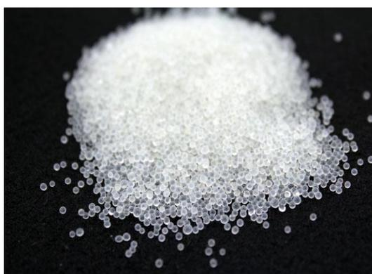
**Figura 3:** Microesferas de vidros
