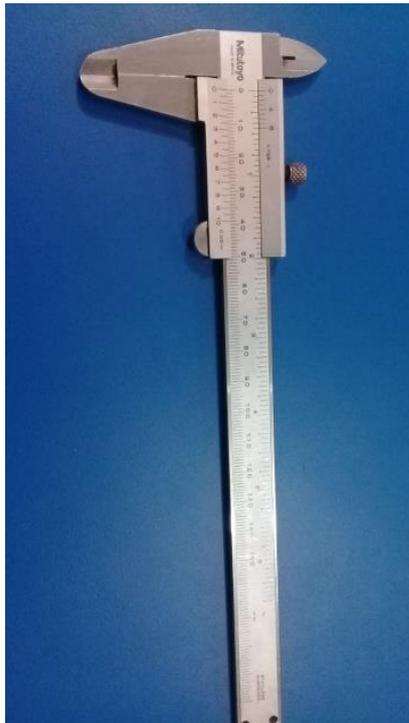
Figura 3.19 – Paquímetro Universal Analógico
