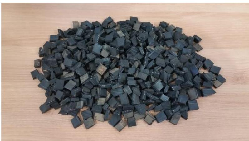
Figura 3.16 – Grãos de Pneus Cortados
