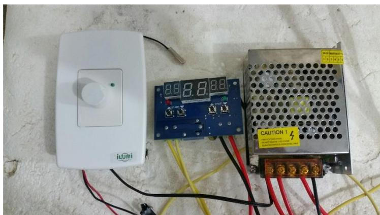
Figura 3.4 – Conjunto *Dimmer*, Termostato e Fonte
