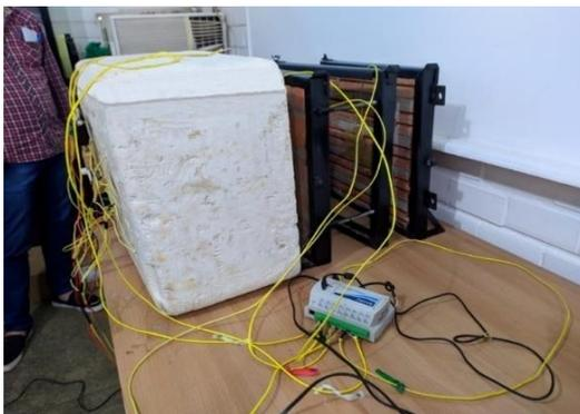
Figura 3.24– Ligações Iniciais dos Termopares
