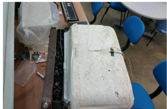
Figura 3.25 – Vista com os pneus picados e termopares instalados
