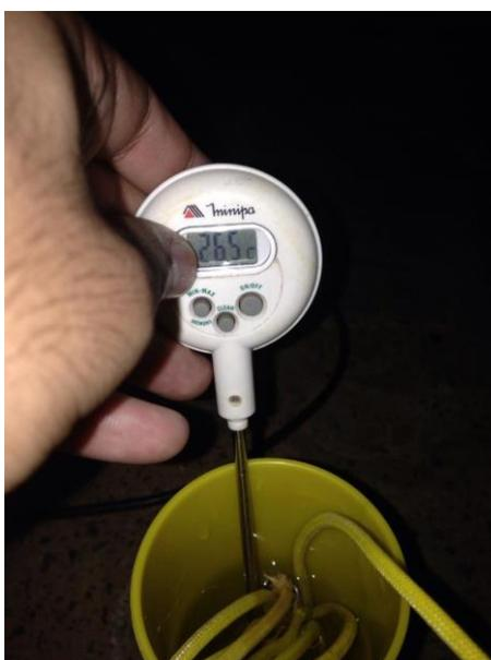
Figura 3.6 – Termômetro de Precisão em uso na Calibração dos Termopares
