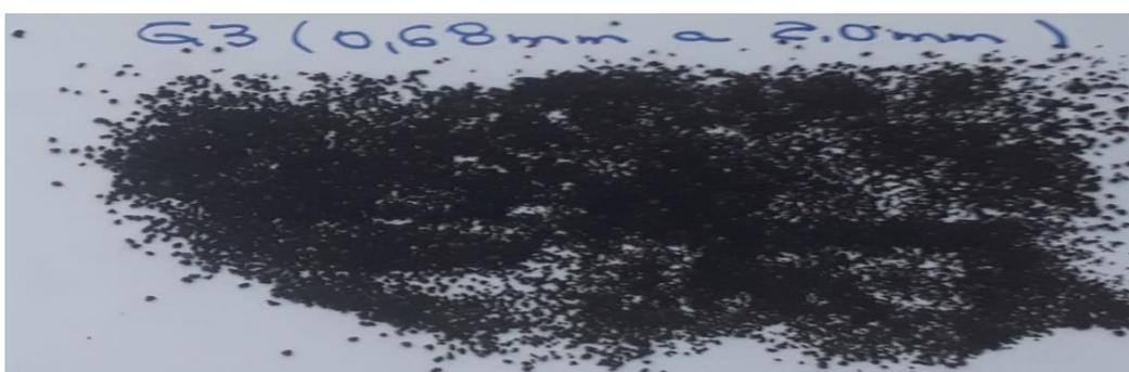
Figura 3.18 – G3 – Granulado de Pneu de Borracha, espessura de 0,68mm a 2mm.
