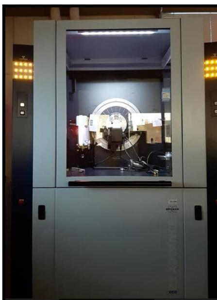
Figura 12: Difratômetro Bruker, modelo D8- Advance.
