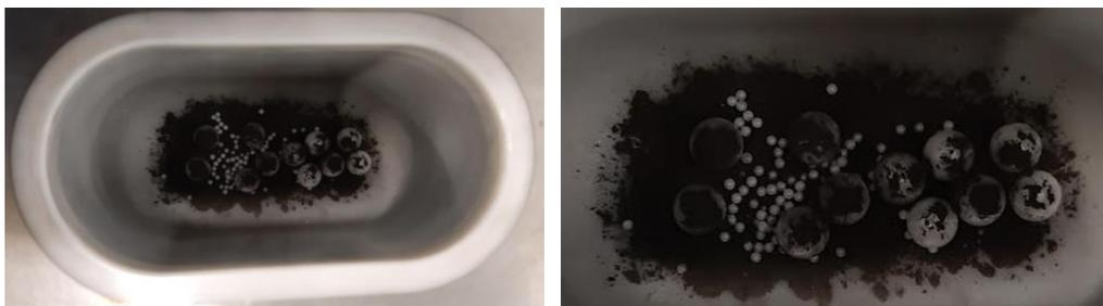
Figura 15: Elementos de moagem : liga reduzida a pó, esferas e jarro.
