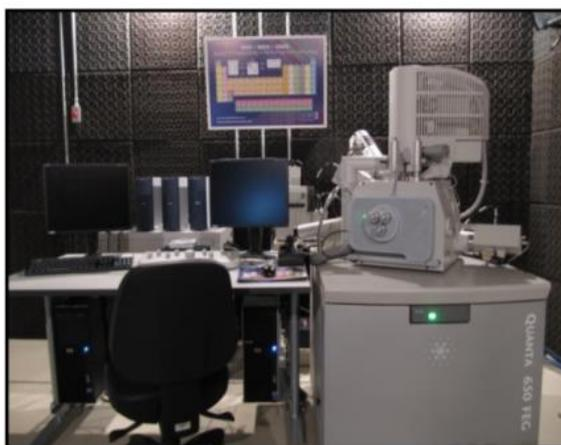
Figura 13: Microscópio eletrônico de varredura modelo: Quanta 650 FEG, marca FEI.
