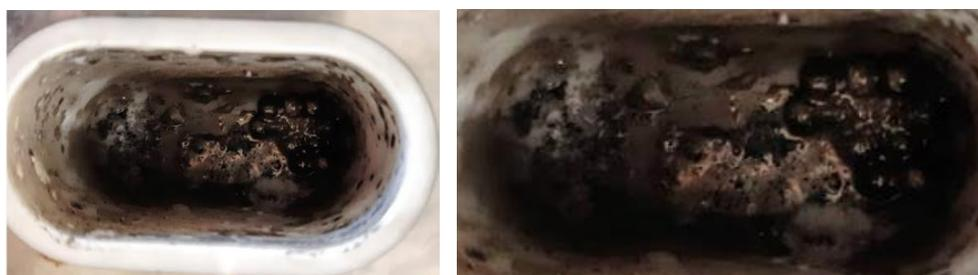
Figura 16: Pasta obtida após a moagem de alta energia do material durante 9 horas na presença de 4 ml de solução.
