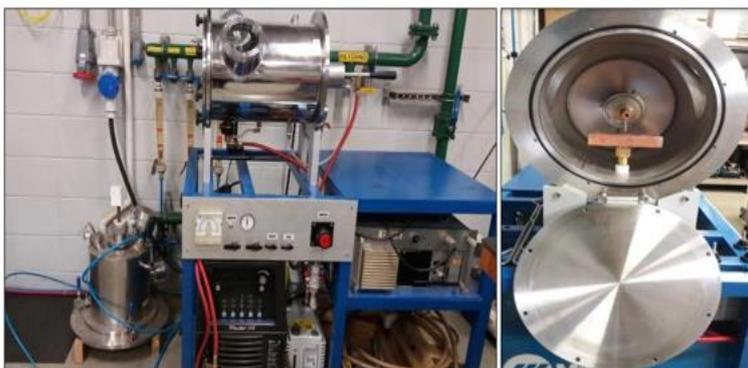
Figura 10: Forno a arco utilizado para elaboração das ligas metálicas.
