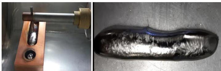
Figura 11: Lingote elaborado após o processo de fusão à arco.
