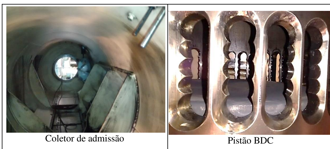
Figura 3.3- Interior do coletor de admissão e o pistão no BDC
