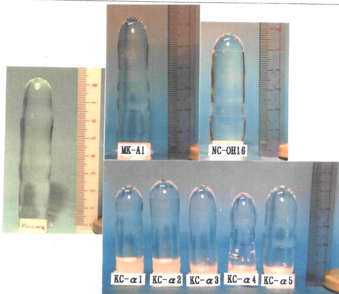
Figura 4.1. Amostras típicas de sílica vítrea obtidas nos experimentos de fusão por Verneuil.
