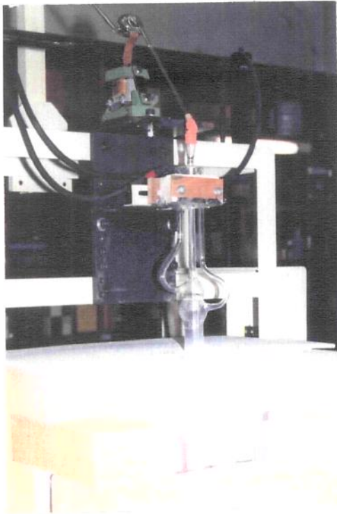
Figura 2.7. Fotografias da montagem (a) e operação (b) do queimados de quartzo fundido.
