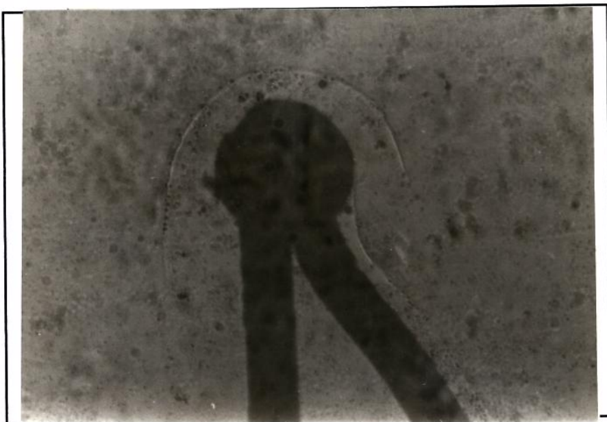
Figura 3.10. Termopar utilizado para medida do gradiente térmico (360x).
