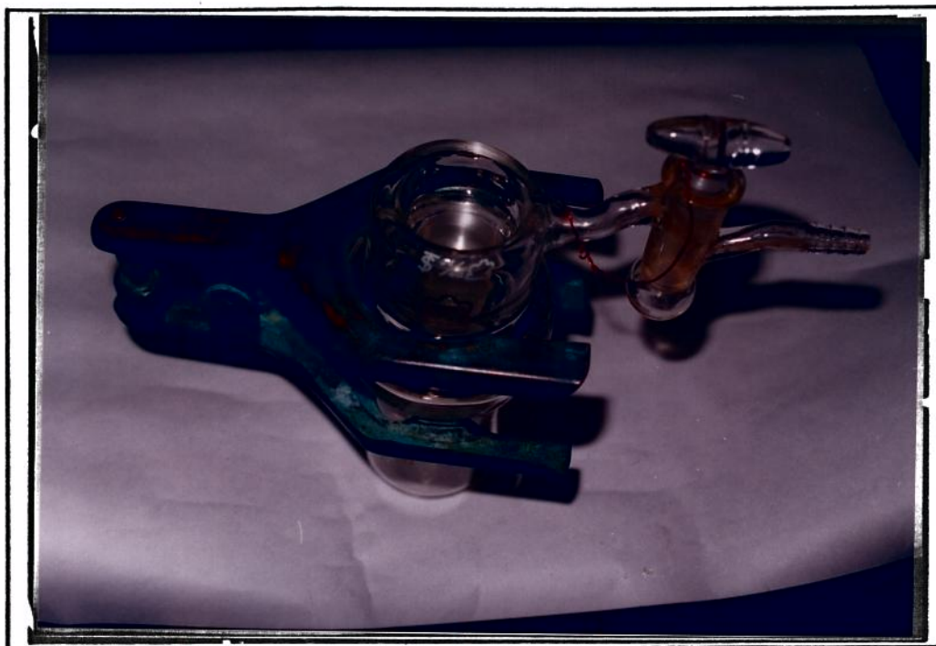
Figura 3.4. Sublimador empregado na purificação do \text{CBr}_4 .
