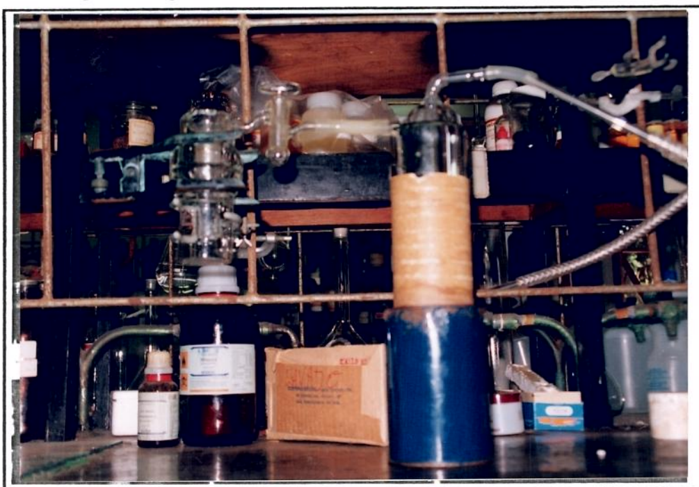
Figura 3.2. Representação esquemática do aparato utilizado na sublimação.
