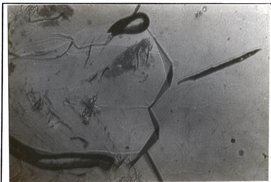
Figura 4.2. Aspecto da interface sólido-líquido facetada obtida para o naftaleno (360x).
