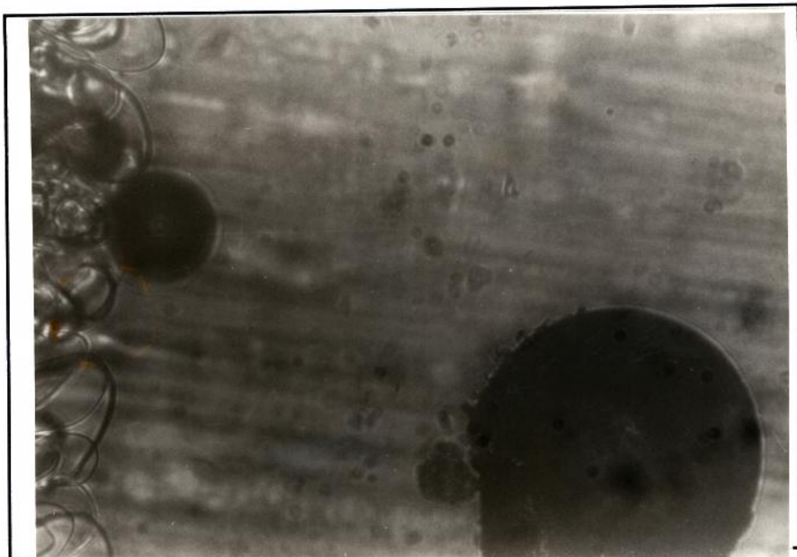
Figura 3.11. Amostra contendo um termopar, apresentando o crescimento de uma interface sólido/líquido dendrítica (360x).
