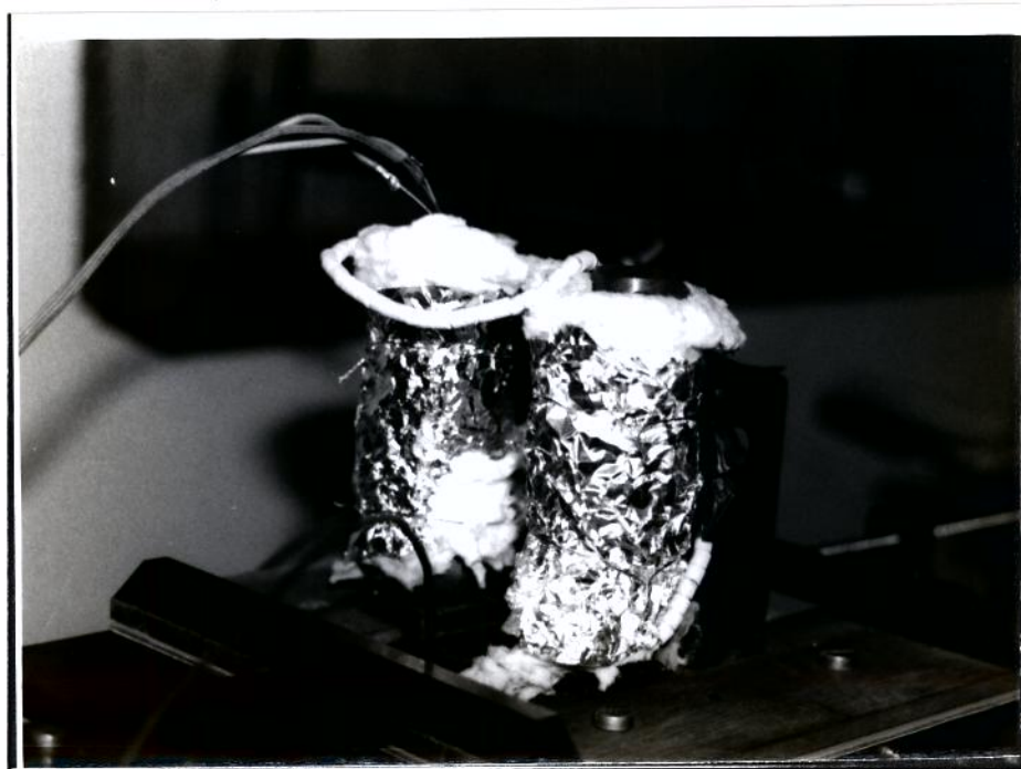
Figura 3.15. Sistema de aquecimento.
