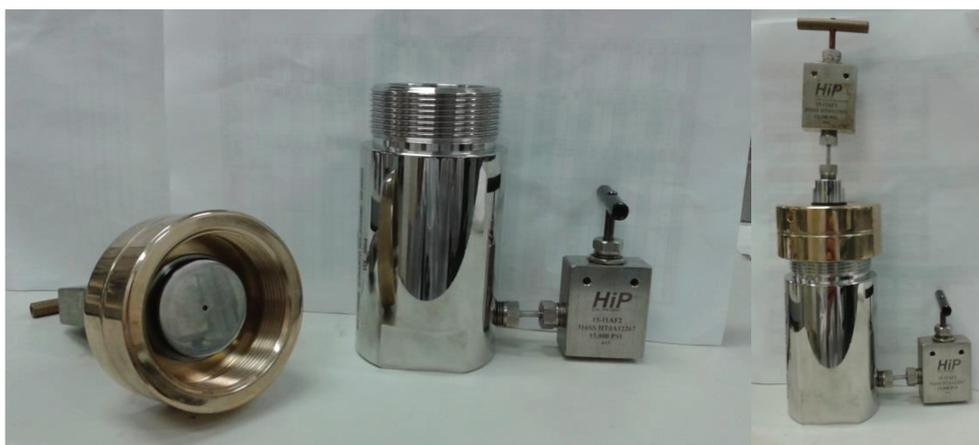
Figura 3-2: Células de confinamento de aço, as quais possuem um orifício de entrada e um orifício de saída.
