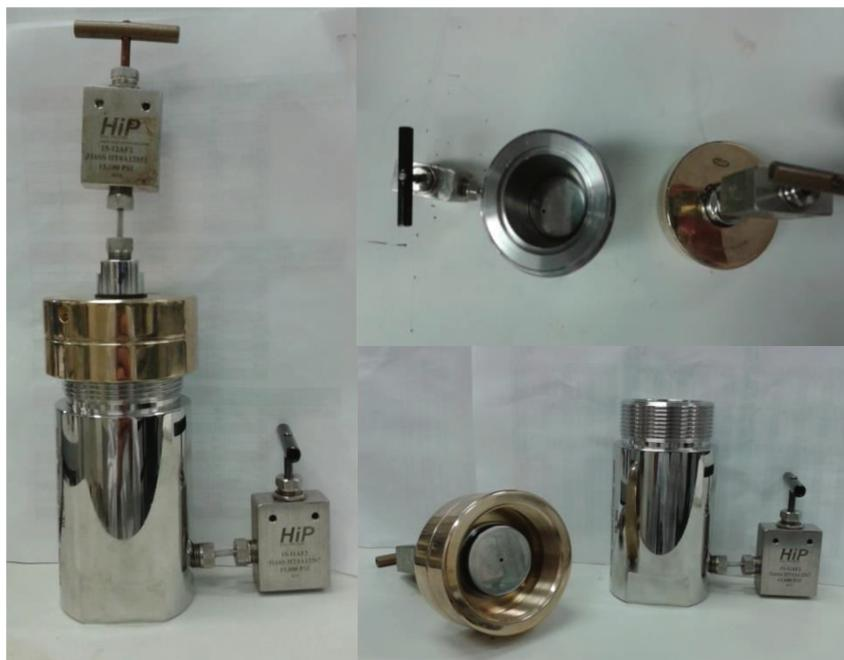
Figura 3-16: Célula de confinamento da rocha e reação de dissolução utilizada no teste de validação e comissionamento do aparato experimental para ensaio em regime estático.
