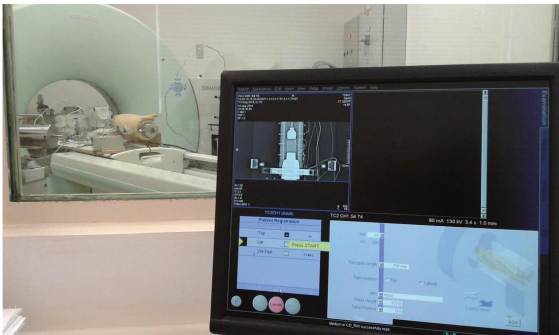
Figura 3-14: Tomógrafo Médico Siemens de 4º geração. Utilizado nos experimentos em regime dinâmico.
