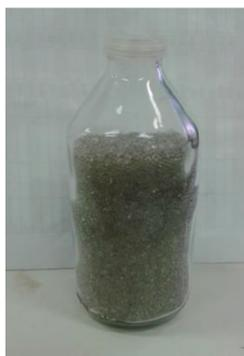
Figura 3-17: Esferas de vidro utilizadas nos experimentos em regime de dissolução estático.
