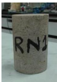
Figura 3-15: Amostra utilizada no teste de validação e comissionamento do aparato experimental para ensaio em regime estático.
