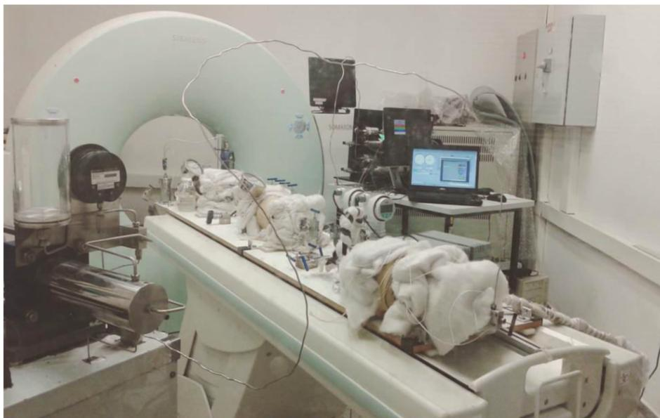
Figura 3-13: Foto do aparato experimental montado na mesa do tomógrafo – Experimentos em regime dinâmico.
