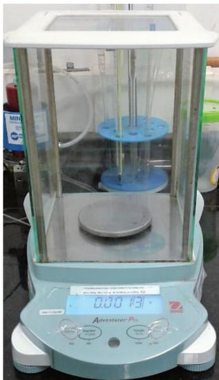
Figura 3-7: Balança analítica.
