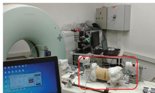
b) *Core holder* envolvido na resistência elétrica
