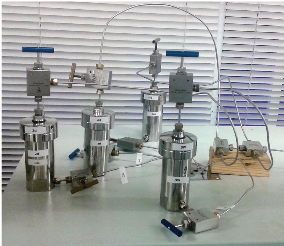
Figura 3-3: Garrafas de aço com pistão interno utilizadas para armazenamento e injeção das salmouras no experimento estático
