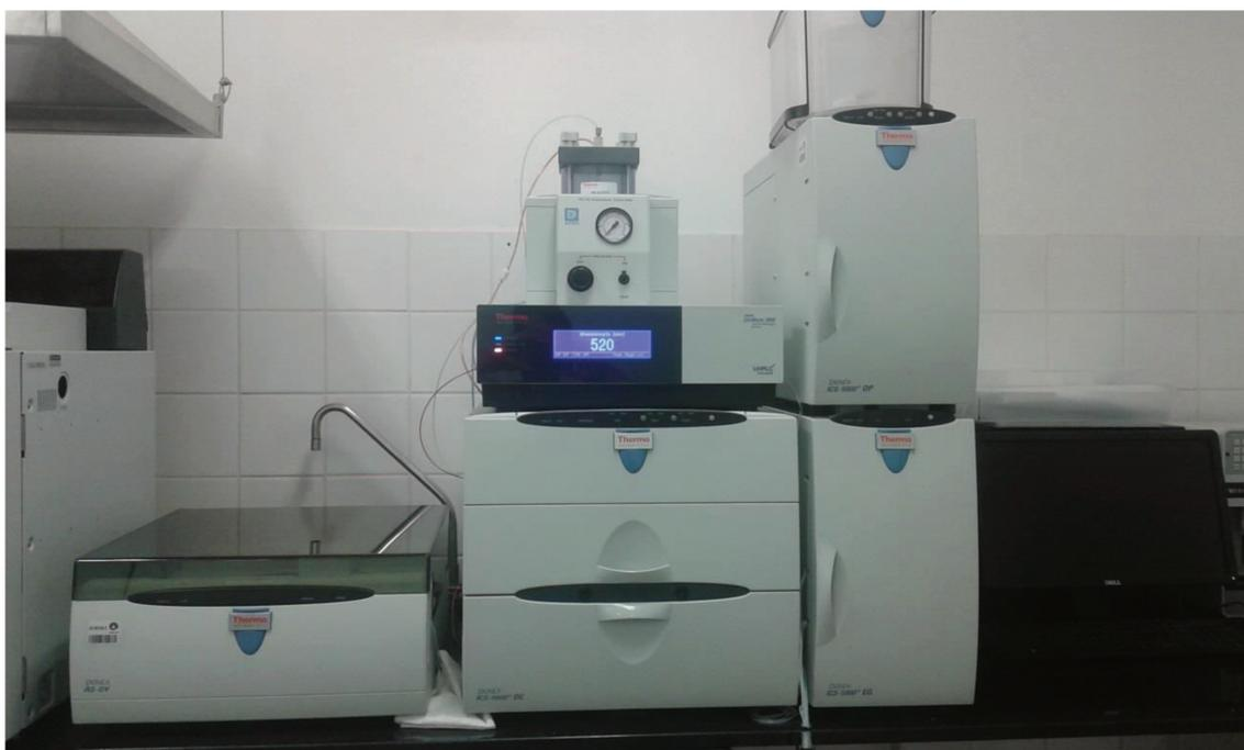
Figura 3-27: Cromatógrafo de Íons da *ThermoScientific* (ICS-5000+)
