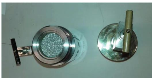
Figura 3-18: Esferas de vidro inseridas na célula de confinamento utilizadas no experimente em regime estático.
