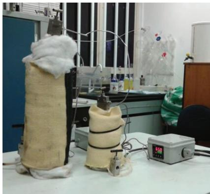
Figura 3-19: Montagem para injeção de água do mar para saturação da rocha. Sistema para o pré-teste em regime estático.
