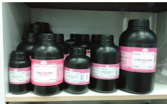
Figura 3-8: Sais utilizados para simular a composição da água do mar, fabricante Synth.
