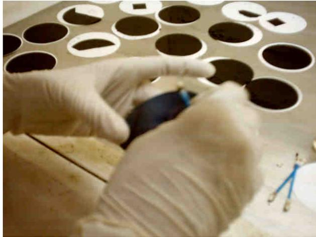
**Figura 6.11** Lâminas cobertas com piche e preparadas para o ataque químico de remoção da camada de fósforo.
