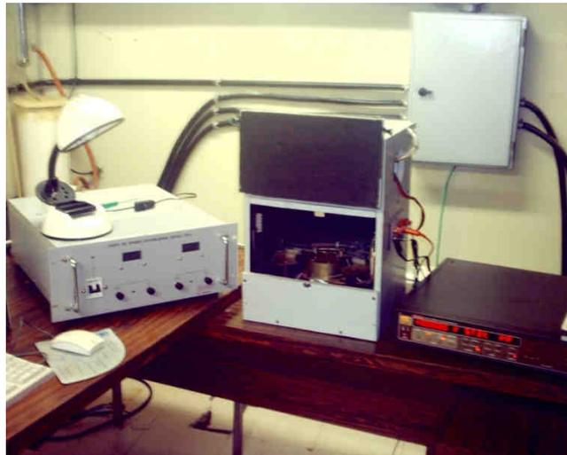
**Figura 6.16** Montagem para medida da curva  $I \times V$  das células do Laboratório de Pesquisas Fotovoltaicas – DFA/IFGW/Unicamp.
