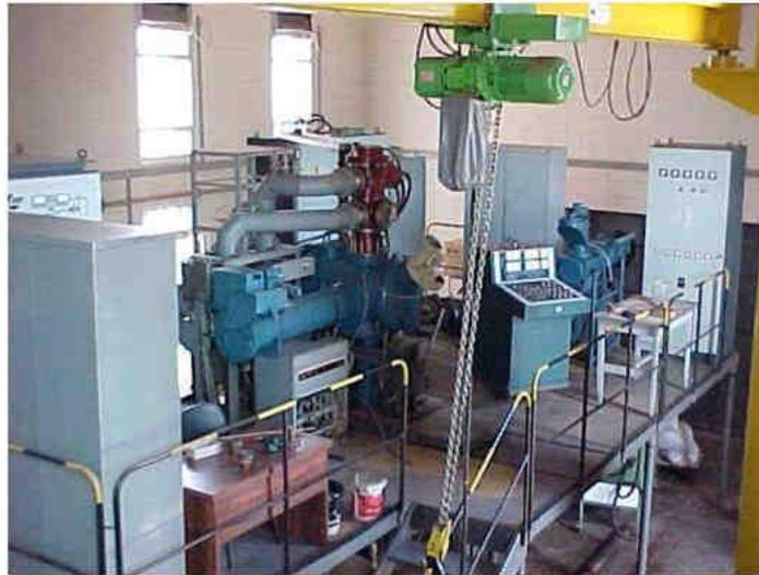
**Figura 6.2** Forno de feixe de elétrons (EBM) localizado no Laboratório de Fusão por Feixe de Elétrons (LFFE)/DEMA/FEM/Unicamp.
