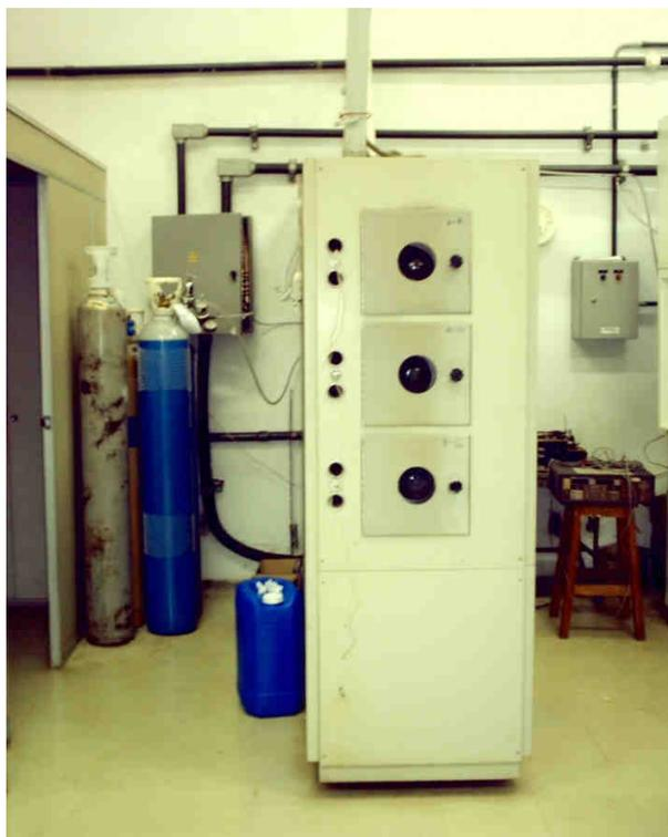
**Figura 6.10** Forno de tubo de quartzo aberto da empresa THERMCO localizado no Laboratório de Pesquisas Fotovoltaicas – DFA/IFGW/Unicamp.
