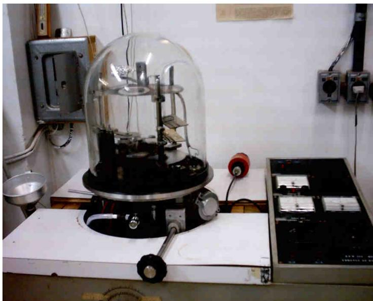
**Figura 6.12** Evaporadora da marca Edward localizada no Laboratório de Pesquisas Fotovoltaicas – DFA/IFGW/Unicamp.
