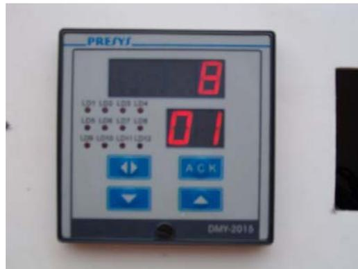
Figura 3.20. Indicador digital de temperatura.
