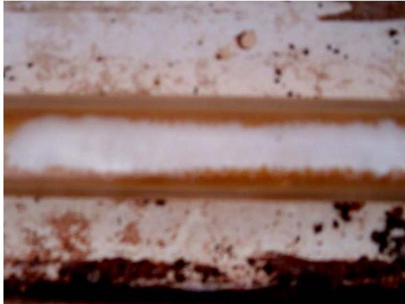
Figura 5.32. Vista de cima do duto após experimento bifásico água- óleo parafínico (1% de parafina).
