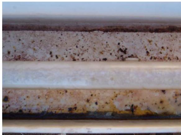
Figura 5.42. Vista de baixo do duto após experimento monofásico óleo parafínico (2% de parafina).
