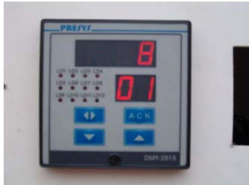
Figura A.2. Indicador digital de temperatura.
