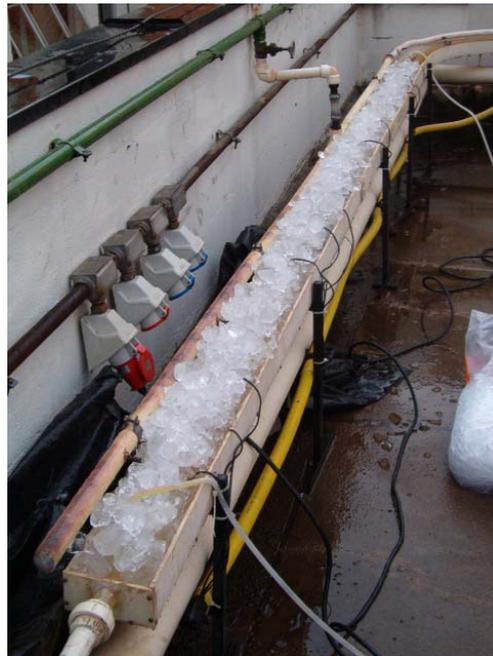
Figura 3.19. Tubulação submersa no banho de água e gelo.
