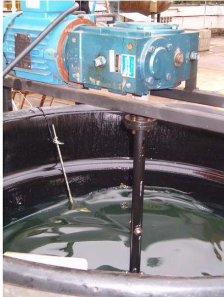
Figura 3.4. Sistema motor - pás giratórias no vaso misturador.
