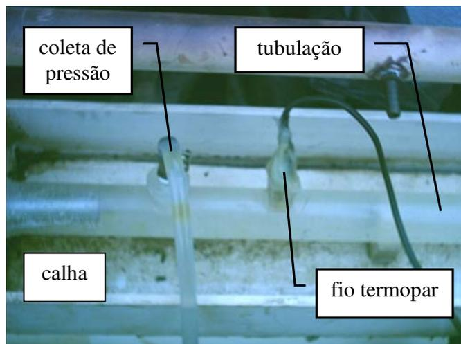
Figura A3. Detalhe da tubulação mostrando o fio termopar conectado ao duto.
