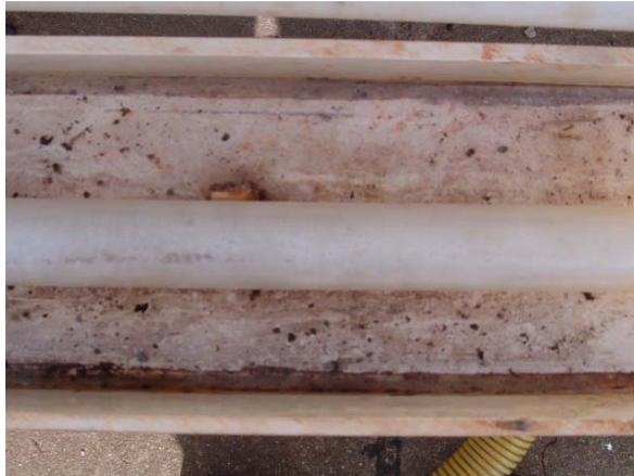
Figura 5.43. Vista de cima do duto após experimento monofásico óleo parafínico (2% de parafina).
