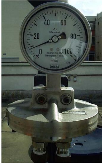
Figura 3.13. Manômetro diferencial de pressão com indicação analógica.
