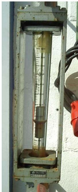
Figura 3.5. Rotâmetro de leitura máxima de 4000 L/h.
