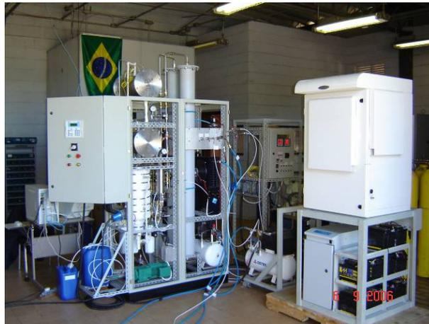
**Figura 5.2 Sistema completo de produção de energia elétrica a partir da reforma de etanol e célula a combustível desenvolvido pelo LH2**
