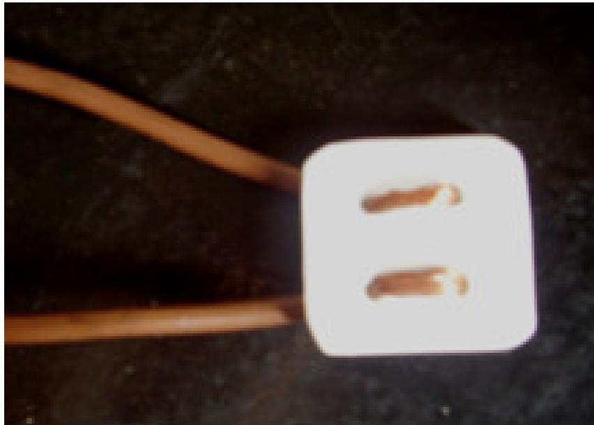
**Figura 2.10** – Disposição dos eletrodos de superfície usados na aquisição de sinal
