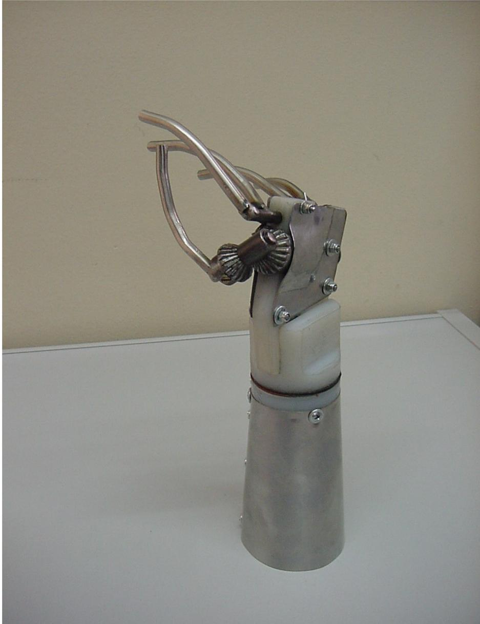
**Figura 5.3** – Vista na posição fechada – polegar em contraposição aos dedos de apoio
