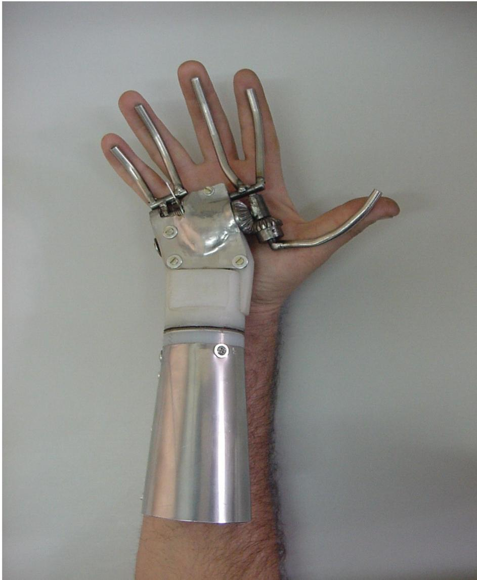
**Figura 5.4** – Comparativo com a mão modelo na posição de abertura total – movimentos e aparência antropomórficos
