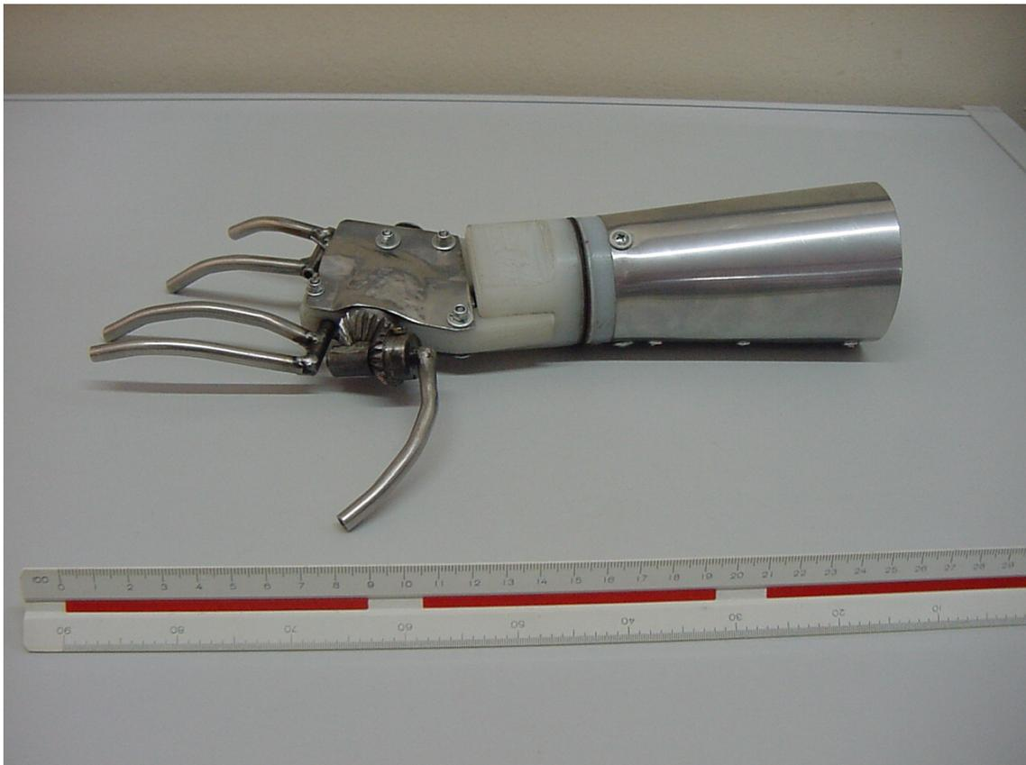
**Figura 4.12** - Implantação do sistema de embreagem na altura do punho
