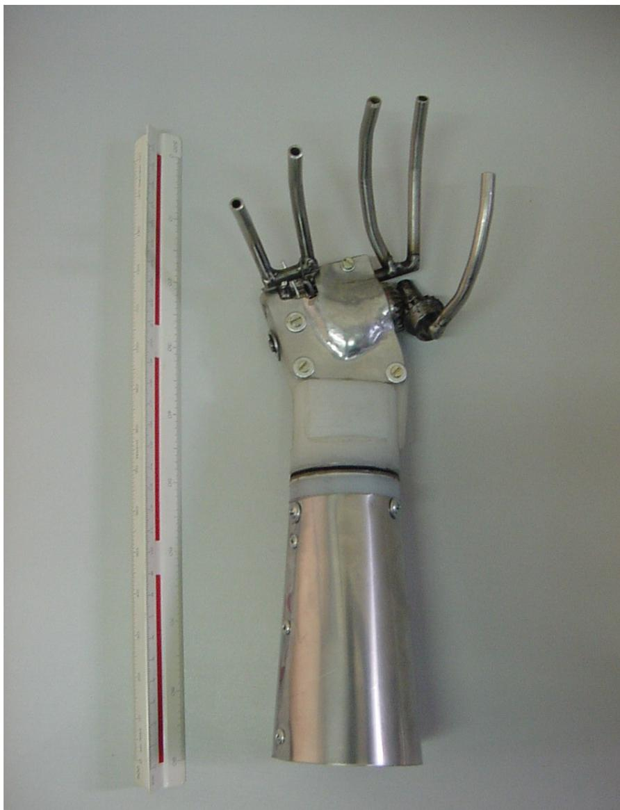
**Figura 5.2** – Estrutura e mecanismo na fase atual – posição semi-aberta
